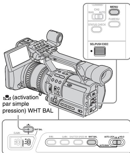
**1** Pendant l'enregistrement ou en mode veille, réglez le commutateur AUTO LOCK sur la position centrale afin de déverrouiller le mode automatique.
