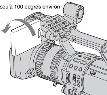
Ouvrez le panneau LCD à 180 degrés, puis faites-le pivoter vers le sujet jusqu'à ce qu'un déclic se fasse entendre.
