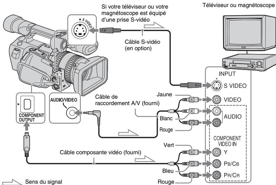
**Raccordez votre caméscope et votre téléviseur ou magnétoscope à l'aide de l'un des câbles décrits ci-dessous.**
