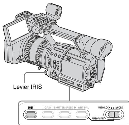
**1** Pendant l'enregistrement ou en mode veille, réglez le commutateur AUTO LOCK sur la position centrale afin de déverrouiller le mode automatique.
