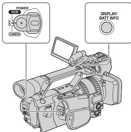
Vous pouvez vérifier le niveau de charge de la batterie et la durée d'enregistrement restante lorsque le caméscope est hors tension. La durée d'enregistrement restante au format d'enregistrement sélectionné s'affiche.
