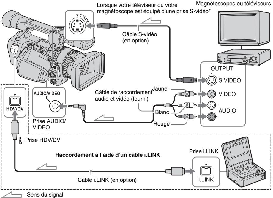
\* Si l'appareil à raccorder dispose d'une prise S-vidéo, raccordez un câble S-vidéo (en option) à cette prise au lieu de la fiche vidéo jaune du câble de raccordement audio et vidéo (fourni). Ce raccordement permet d'obtenir des images au format DVCAM (DV) de meilleure qualité. Le son n'est pas émis si vous effectuez un raccordement avec le câble S-vidéo uniquement.
