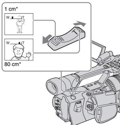
\* Distance minimale nécessaire entre le caméscope et le sujet pour obtenir une mise au point nette si vous appuyez sur ce côté-ci de la manette.
