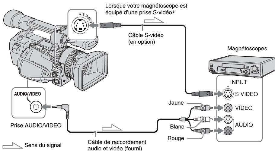
\* Si l'appareil à raccorder dispose d'une prise S-vidéo, raccordez un câble S-vidéo (en option) à cette prise au lieu de la fiche vidéo jaune du câble de raccordement audio et vidéo (fourni). Ce raccordement permet d'obtenir des images au format DVCAM (DV) de meilleure qualité. Le son n'est pas émis si vous effectuez un raccordement avec le câble S-vidéo uniquement.
