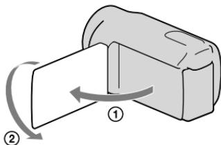
Ouvrez le panneau LCD à 90 degrés par rapport au caméscope (①), puis faites-le pivoter à 180 degrés vers l'objectif (②).
