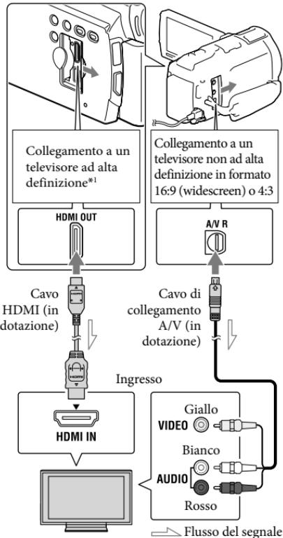
\* Se il televisore non dispone della presa di ingresso HDMI, utilizzare il cavo di collegamento A/V per il collegamento.
