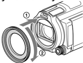
Richten Sie den Reduzierring richtig am Camcorder aus (①) und drehen Sie ihn anschließend in Pfeilrichtung, bis der Reduzierring einrastet (②).
