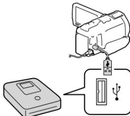
**2 Sélectionnez [Connexion USB] sur l'écran du caméscope.**
