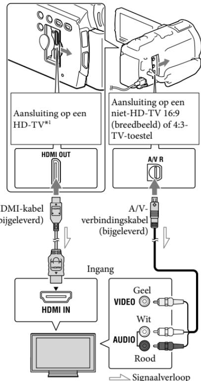
\* Als het TV-toestel geen HDMI-ingang heeft, gebruikt dan de A/V-verbindingkabel voor de aansluiting.
