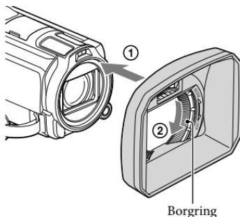
Plaats de lenskap goed op de camcorder (①) en draai de borgring van de lenskap in de richting van het pijltje (②).
