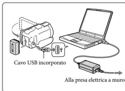
Per caricare la batteria da una presa elettrica a muro utilizzando il cavo USB incorporato
