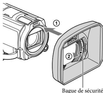
Alignez correctement le pare-soleil avec le caméscope (①), puis tournez la bague de sécurité du pare-soleil dans la direction de la flèche (②).
