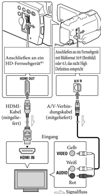
\* Wenn das Fernsehgerät keine HDMI-Eingangsbuchse hat, verwenden Sie das A/V-Verbindungsleitung für den Anschluss.
