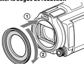
Alignez correctement avec la bague de réduction avec le caméscope (①), puis tournez-la dans la direction de la flèche jusqu'à ce que se verrouille en position (②).
