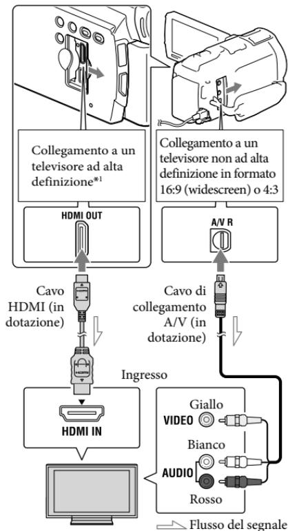
\* Se il televisore non dispone della presa di ingresso HDMI, utilizzare il cavo di collegamento A/V per il collegamento.
