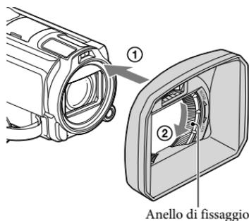
Allineare correttamente il paraluce con la videocamera (①), quindi ruotare l'anello di fissaggio del paraluce nella direzione della freccia (②).
