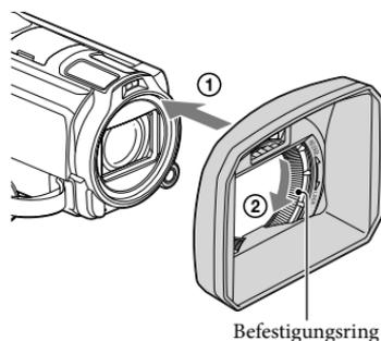
Richten Sie die Gegenlichtblende richtig am Camcorder aus (1) und drehen Sie dann den Befestigungsring der Gegenlichtblende in Pfeilrichtung (2).
