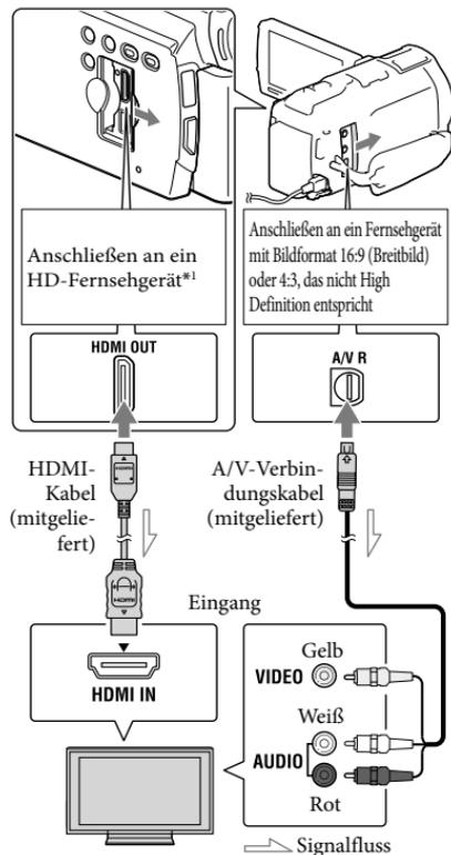
\* Wenn das Fernsehgerät keine HDMI-Eingangsbuchse hat, verwenden Sie das A/V-Verbindungskabel für den Anschluss.
