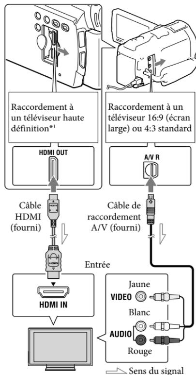
\* Si le téléviseur n'est pas équipé d'une prise d'entrée HDMI, utilisez le câble de raccordement A/V pour la connexion.
