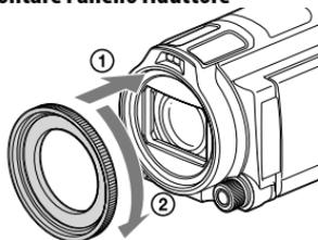
Allineare correttamente l'anello riduttore con la videocamera (①), quindi ruotarlo nella direzione della freccia finché si blocca in sede (②).
