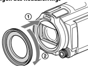
Richten Sie den Reduziering richtig am Camcorder aus (1) und drehen Sie ihn anschließend in Pfeilrichtung, bis der Reduziering einrastet (2).
