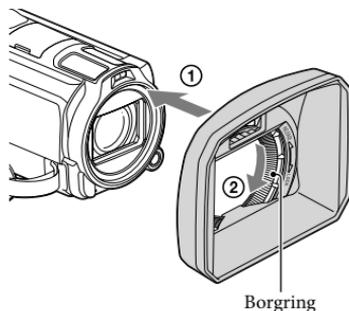
Plaats de lenskap goed op de camcorder (1) en draai de borgring van de lenskap in de richting van het pijltje (2).
