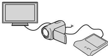
① Collegare l'alimentatore CA e il cavo di alimentazione alla DC IN presa della videocamera e alla presa elettrica a muro (p. 13).
