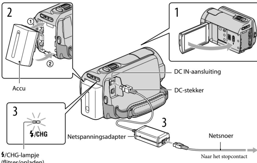
U kunt de "InfoLITHIUM"-accu (V-reeks) opladen nadat u deze in de camcorder hebt geplaatst.
