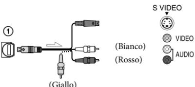
Cavo di collegamento A/V (in dotazione)
