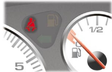
Dès la mise du contact, si un passager avant n'a pas bouclé sa ceinture et si la vitesse du véhicule est inférieure à 20 km/h, vous êtes alerté par le témoin de ceinture qui s'allume.
