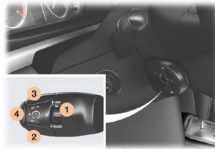
Il permet de ne pas dépasser la vitesse du véhicule programmée par le conducteur (vitesse minimum de 30 km/h).
