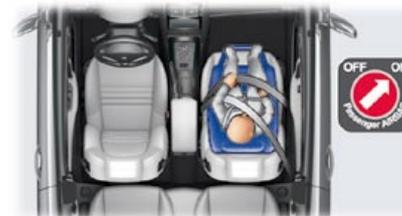
Lorsqu'un siège enfant «face à la route» est installé en **place passager avant**, réglez le siège du véhicule en position longitudinale intermédiaire dossier redressé et laissez l'airbag passager actif.
