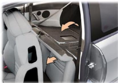
**Remarque** : l'assise monobloc 1 peut être retirée, avec précaution, pour augmenter le volume de chargement. Pincez les fixations de l'assise pour les dégager de leurs attaches.
