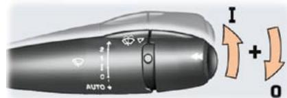
L'intervention manuelle sur la commande d'essuie-vitre en déplaçant la manette **A** vers le haut et en la replaçant en position «**0**» interrompt la position **AUTO**, le témoin de neutralisation s'allume dans l'écran du combiné, accompagné d'un message sur l'écran multifonction.
