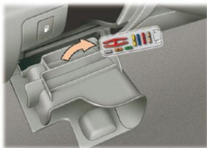
Utilisez la pince spéciale située sur le support à côté de la boîte à fusibles, ce support contient également les fusibles de rechange.
