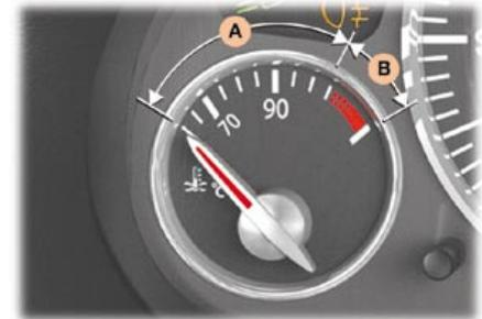
**Indicateur de température du liquide de refroidissement**
