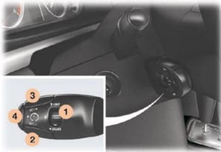
Il permet de maintenir, de façon constante, la vitesse du véhicule programmée par le conducteur.
