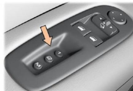
La mémorisation prend en compte le réglage électrique du siège conducteur, du volant et des rétroviseurs extérieurs.
