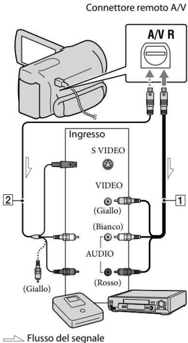
[1] Cavo di collegamento A/V (in dotazione)
