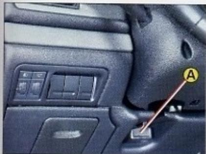
Le volant peut être réglé en hauteur et en profondeur.
