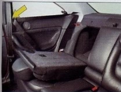
Avant toute manipulation, pour éviter la détérioration des ceintures de sécurité, placez-les dans les encoches prévues à cet effet.
