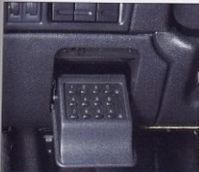
Ce dispositif antivol permet le verrouillage du système de contrôle moteur par l'introduction d'un code personnel à quatre chiffres.
