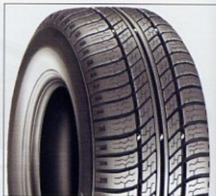
La profondeur de sculpture des pneus doit être vérifiée régulièrement car les performances d'adhérence diminuent avec l'usure. Des témoins sur la bande de roulement indiquent la limite d'utilisation en toute sécurité des pneumatiques.
