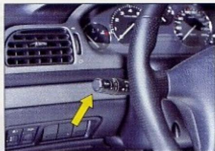
La commande au volant permet d'actionner l'éclairage, les feux de brouillard avant et arrière, l'avertisseur optique, les indicateurs de changement de direction et l'avertisseur sonore.
