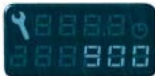
5 secondes après la mise du contact, le totalisateur kilométrique reprend son fonctionnement normal et la clé reste allumée.
