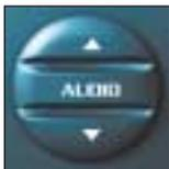
Effectuez des pressions successives sur la touche "**AUDIO**" pour accéder aux réglages des graves (**BASS**), des aigus (**TREB**), du loudness (**LOUD**), du fader (**FAD**), de la balance (**BAL**) et de la correction automatique du volume (**CAV**).
