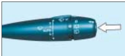
Chaque pression sur le bouton situé à l'extrémité de la **commande d'essuie-vitre** permet d'afficher alternativement :
