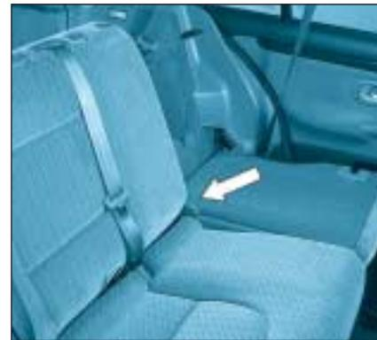
En configuration banquette un tiers rabattue avec passagers arrière, dégagez la boucle de la ceinture centrale du boîtier.
