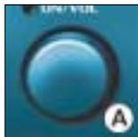
La clé de contact étant en position ACCESSOIRES ou CONTACT, appuyez sur le bouton **A** pour mettre en marche ou arrêter l'autoradio.
