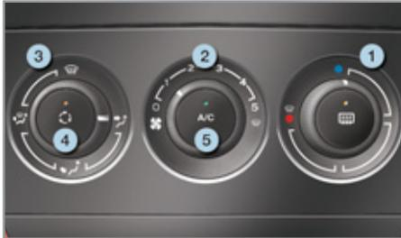
L'air conditionné ne peut fonctionner que moteur tournant.
