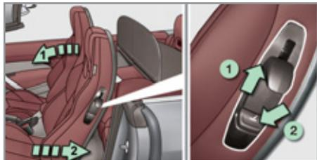
1. Commande de déverrouillage du dossier et avancée automatique du siège.
