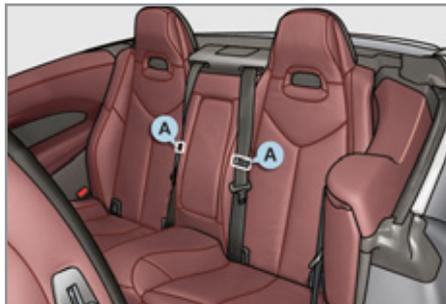
**i** En configuration «cabriolet», lorsqu'il n'y a pas de passagers aux places arrière, glissez les sangles dans les passants **A** pour éviter tout flottement des ceintures arrière (uniquement sièges en cuir).
