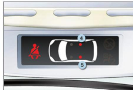
A la mise du contact, moteur tournant ou véhicule roulant à une vitesse inférieure à environ 20 km/h, les témoins correspondants **4** et **5** s'allument environ 30 secondes en rouge, si la ceinture n'est pas bouclée.
