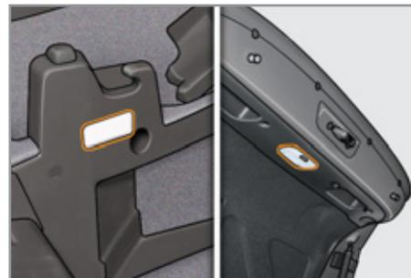
Votre véhicule est équipé de deux éclairages de coffre ; un premier dans la garniture latérale gauche du coffre et un second dans la garniture intérieure du volet de coffre.
