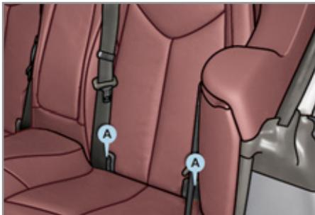
Il s'agit de deux anneaux **A** pour chaque assise, situés entre le dossier et l'assise du siège du véhicule, signalés par une étiquette.
