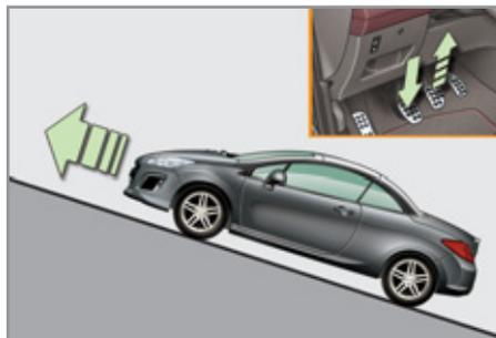
**En pente montante, véhicule à l'arrêt, le véhicule est maintenu un court instant dès que vous relâchez la pédale de frein et que vous êtes en première vitesse ou au point mort.**
