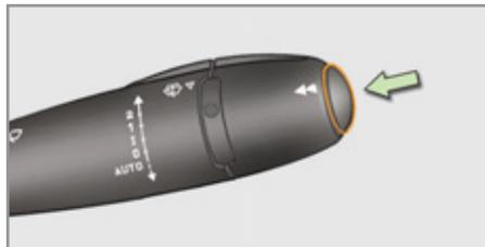
☞ Appuyez sur le bouton, situé à l'extrémité de la **commande d'essuie-vitre**, pour afficher successivement les différents onglets de l'ordinateur de bord.
