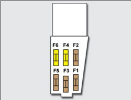
Tableau des fusibles au-dessus de la batterie
