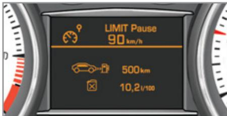
! Suivant l'équipement de votre véhicule, les informations de l'ordinateur de bord apparaissent dans l'écran multifonction ou dans l'afficheur central du combiné.
