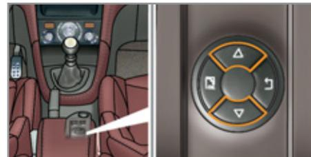
☞ Appuyez sur les flèches haut et bas du **désignateur** du combiné, associé au WIP Com 3D, pour afficher successivement les différents onglets de l'ordinateur de bord.
