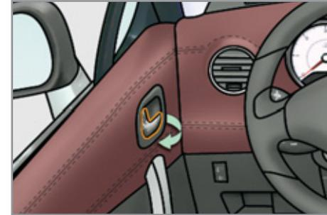
☞ Tirez la commande de porte pour ouvrir la porte ; celle-ci déverrouille tout le véhicule.
