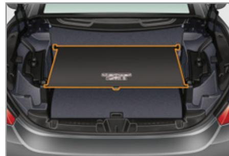
En configuration «cabriolet», il permet de délimiter l'espace pour le chargement de vos bagages dans le coffre.
