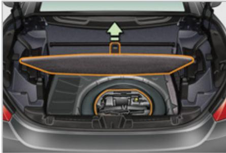
Les outils sont installés dans le coffre sous le plancher.
