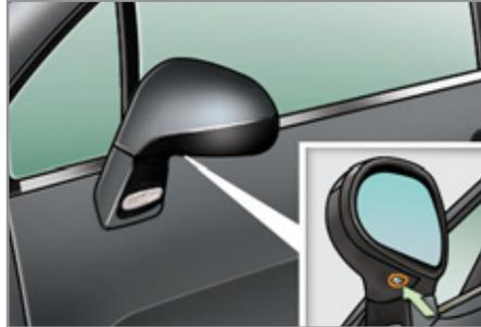
Pour le remplacement de ce type de lampe à diodes, consultez le réseau PEUGEOT ou un atelier qualifié.
