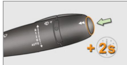
☞ Lorsque le parcours désiré est affiché, appuyez plus de deux secondes sur le bouton, situé à l'extrémité de la **commande d'essuie-vitre**.
