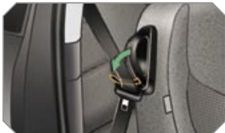
Sur les versions 3 portes, abaissez le support intégré à la commande pour reposer la ceinture dessus. Il vous permet de récupérer plus facilement la ceinture, quand vous devez la remettre.
