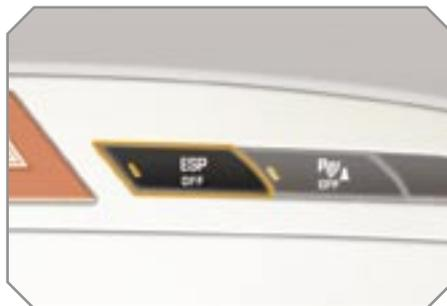
☞ Appuyez sur le bouton «**ESP OFF**», situé au milieu de la planche de bord.
