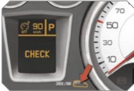
☞ Moteur tournant, pour lancer un check manuel, appuyez sur le bouton «CHECK/000» du combiné.
