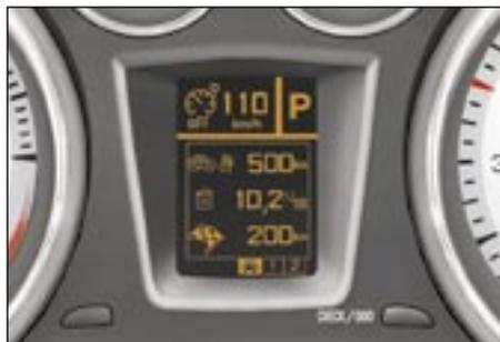
**i** Suivant l'équipement de votre véhicule, les informations de l'ordinateur de bord apparaissent dans l'écran ou dans le grand afficheur du combiné.
