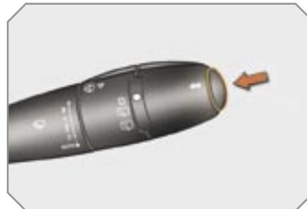
☞ Appuyez sur le bouton, situé à l'extrémité de la **commande d'essuie-vitre**, pour afficher successivement les différents onglets de l'ordinateur de bord :
