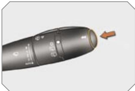
Appuyez sur le bouton, situé à l'extrémité de la **commande d'essuie-vitre**, pour afficher successivement les différentes données de l'ordinateur de bord.
