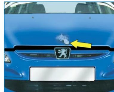
**A l'extérieur**: levez la commande, soulevez le capot et fixez la béquille pour maintenir le capot ouvert.
