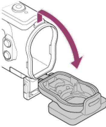
**3** Insérez le caméscope dans le corps du boîtier.
