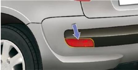
Le feu antibrouillard est situé sur le pare-chocs arrière, côté gauche.
