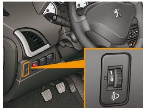
En fonction de la charge de votre véhicule, il est recommandé de corriger le faisceau des phares.
