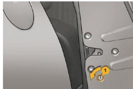
Elle interdit l'ouverture de l'intérieur de chacune des portes arrière.
