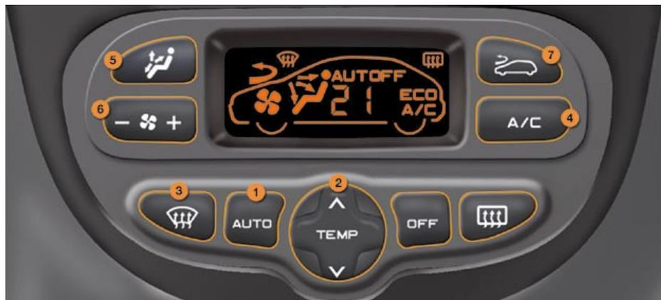
L'air conditionné ne peut fonctionner que moteur tournant.
