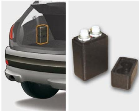
Pour les véhicules non équipés de roue de secours, vous disposez de deux aérosols de dépannage des pneumatiques, rangés dans une boîte isotherme, dans le coffre.
