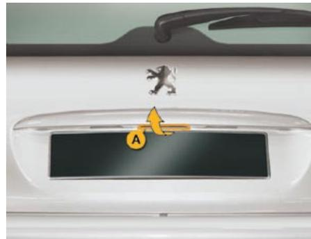
Le verrouillage et le déverrouillage du coffre est simultanément à celui des portes.
