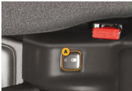
L'appui sur le bouton **A** vous permet de verrouiller/déverrouiller des portes.
