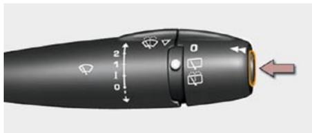
Chaque pression sur le bouton situé à l'extrémité de la **commande d'es-sule-vitre** permet d'afficher alternativement :
