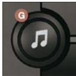
Effectuez des pressions successives sur la touche **G** pour accéder aux réglages des graves (**BASS**), des aigus (**TREB**), du loudness (**LOUD**), du fader (**FAD**), de la balance (**BAL**) et de la correction automatique du volume.
