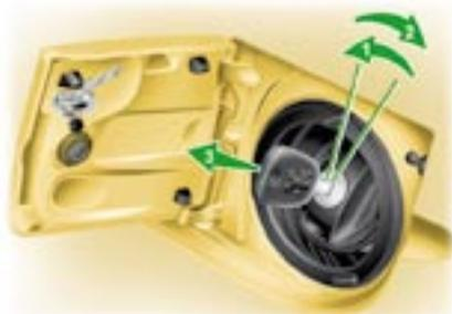
Après avoir ouvert la trappe, introduisez la clé puis tournez légèrement vers la gauche et ensuite revenez vers la droite. La clé revient dans sa position initiale et le bouchon est déverrouillé.
