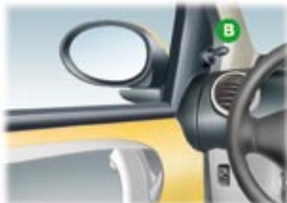
**B.** Commande de réglage des rétroviseurs extérieurs.
