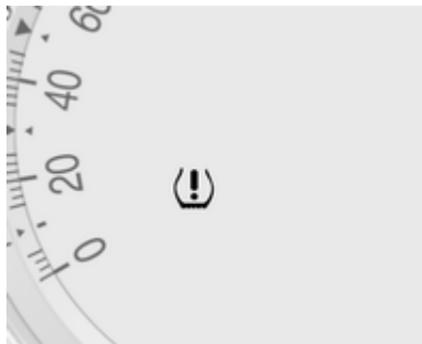
En cas de détection d'une basse pression de pneu, le témoin (⚠) s'allume. S'arrêter dès que possible et gonfler les pneus à la pression recommandée ↪ 182.
