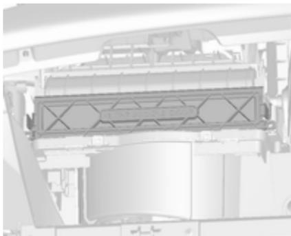
2. Déposer le couvercle de filtre en poussant sur ses deux côtés et en le tirant.
