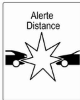
Lors de l'approche trop rapide d'un autre véhicule, la page d'alerte de collision sera affichée sur le centre d'informations du conducteur. En même temps, un signal sonore retentira. Enfoncer la pédale de frein, si cela est exigé par la situation.
