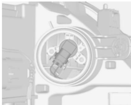
2. Déposer le socquet d'ampoule en tirant.
