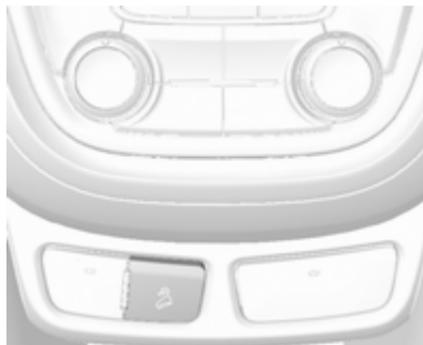
À des vitesses inférieures à environ 40 km/h, appuyer sur le bouton
