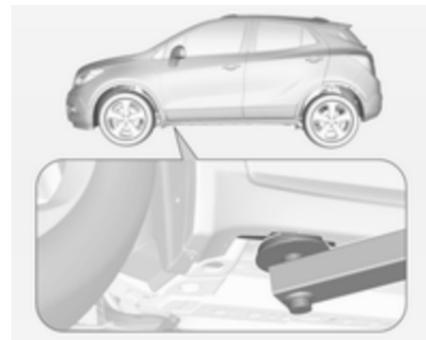
Positionner le bras avant du pont élévateur au niveau du soubassement.
