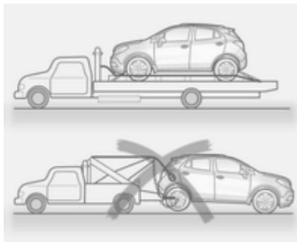
La meilleure façon de transporter le véhicule est d'utiliser un véhicule de dépannage.
