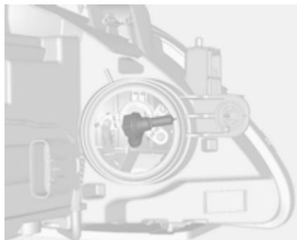
3. Déposer l'ampoule de son socquet et la remplacer.
