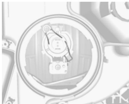
2. Appuyer sur l'attache ressort, la désencliquer.
