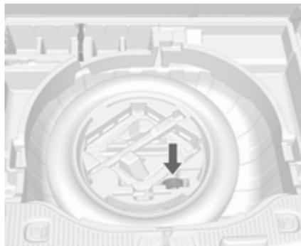
Une roue de plein format endommagée doit être rangée dans le coffre et attachée avec une sangle. Outillage de bord ↗ 180. Pour fixer la roue :
