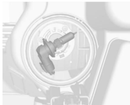
1. Déposer le soquet d'ampoule en tirant.
