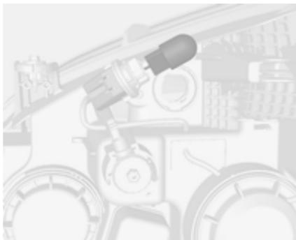
2. Pousser légèrement l'ampoule dans le socle, la faire tourner dans le sens inverse des aiguilles d'une montre, la déposer et la remplacer.
