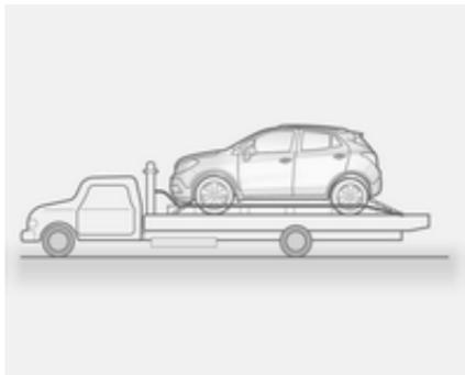
Afin d'éviter tout dégât, un équipement à plateau offre la meilleure méthode de remorquage du véhicule équipé de la transmission intégrale. Si un plateau n'est pas disponible, utiliser un chariot de remorquage pour remorquer le véhicule, comme illustré ci-dessous.
