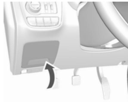
La boîte à fusibles se trouve derrière un cache du tableau de bord, côté conducteur.
