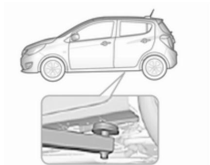
Position du bras arrière du pont élévateur, positionné centralement sous le creux du seuil.
