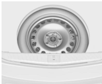
La roue de secours se trouve dans la niche de la roue de secours, sous le recouvrement de plancher.
