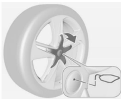
Roues en alliage léger avec capuchon d'écrou central : Dégager le capuchon central en insérant et en tirant l'extracteur ↗ 187 dans le creux de l'emblème de la marque.
