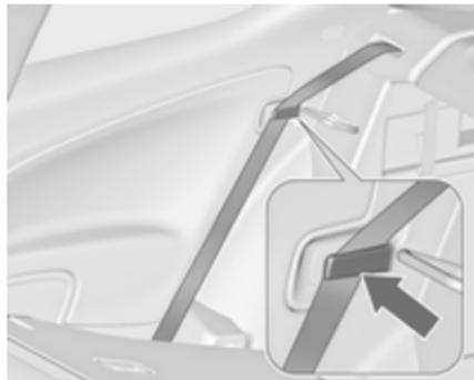
Sortir la ceinture de sécurité du guide de dossier de siège et la passer derrière l'attache comme illustré.
