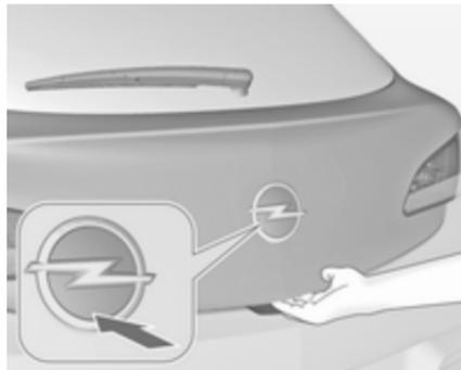
Appuyer sur le bouton
