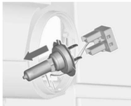
3. Désengager l'ampoule du connecteur en tirant.
