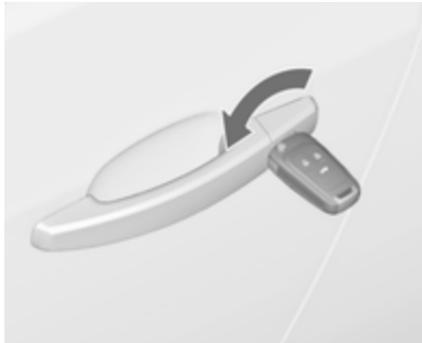
Déverrouiller manuellement la porte du conducteur en tournant la clé dans la serrure. Mettre le contact et appuyer sur le bouton de verrouillage central
