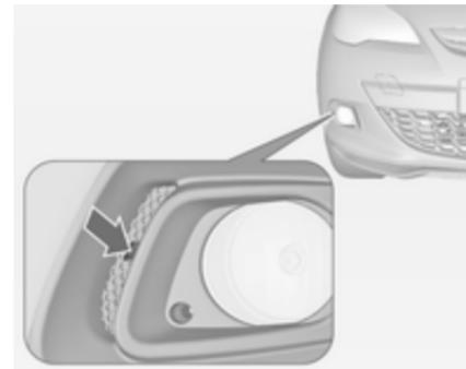
1. Décliqueter le couvercle avec un tournevis dans le logement et déposer le cache.
