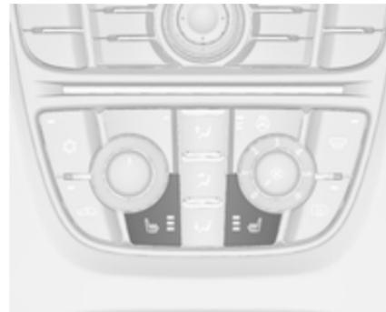
En fonction du niveau de chauffage voulu, appuyer une ou plusieurs fois sur le bouton
