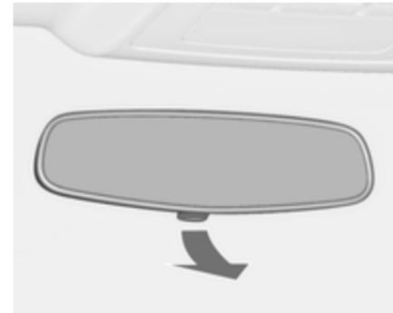
Pour réduire l'éblouissement, régler le levier sous le rétroviseur.
