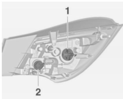
5. Retirer et remplacer l'ampoule en tournant la douille d'ampoule dans le sens antihoraire.
