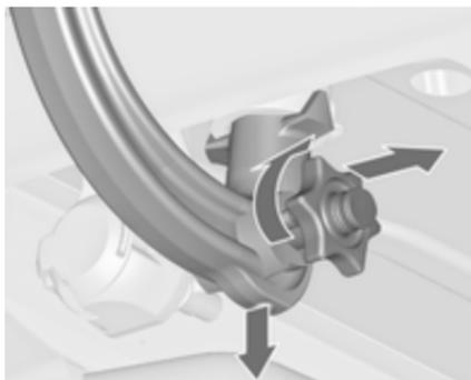
Ouvrir le volet de protection et tourner la clé en position
