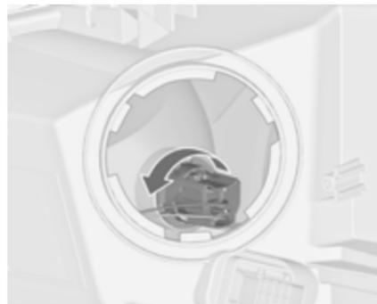
2. Tourner la douille d'ampoule dans le sens antihoraire et enlever.
