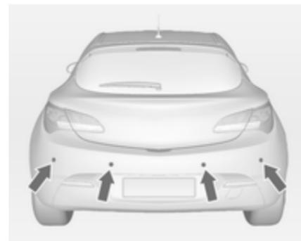
L'aide au stationnement facilite les manœuvres en mesurant la distance entre le véhicule et les obstacles et en émettant des signaux sonores.
