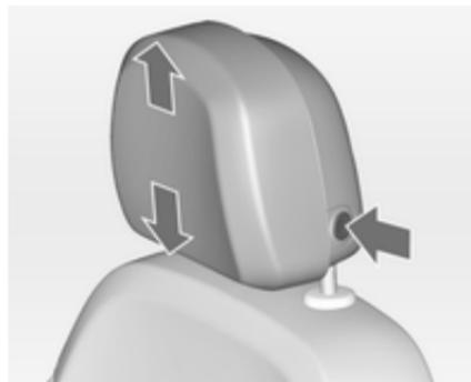
Appuyer sur le bouton, régler la hauteur et encliquer.
