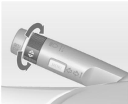
Les panneaux routiers sont affichés sur la page **Détection des panneaux routiers** dans le **Menu informations trajet/carbur.**, en sélectionnant avec la roue moletée de la manette des clignotants ↻ 85.
