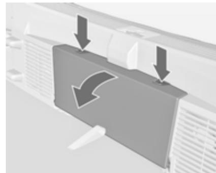
2. Déposer le rangement à l'arrière : appuyer sur les deux boutons et replier le cache. Sortir le rangement par le haut.
