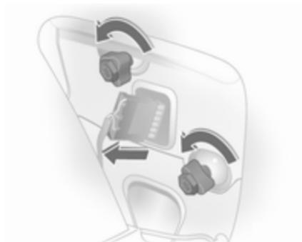
3. Desserrer les écrous de fixation à l'aide d'une clé pour boulons de roue et les dévisser à la main. Outilillage de bord  $\varnothing$  194.
