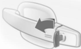
La clé de secours peut uniquement verrouiller ou déverrouiller la porte du conducteur. Déverrouillage de tout le véhicule ↻ 24. Sur les véhicules avec alarme antivol, l'alarme peut retentir quand le véhicule est déverrouillé. Désactiver l'alarme en mettant le contact.
