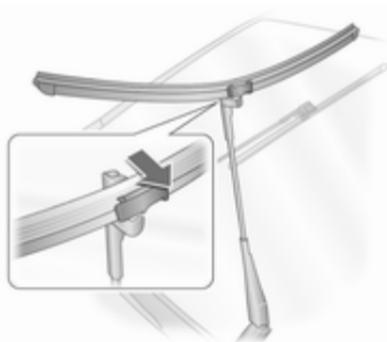
Soulever le bras d'essuie-glace, pivoter le balai à 90° par rapport au bras et le déplacer sur le côté.
