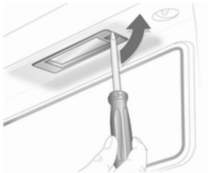
1. Introduire un tournevis dans le boîtier ; appuyer sur le côté et déverrouiller le ressort.
