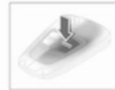
Verrouiller le véhicule à l'arrêt. Appuyer à nouveau sur le bouton
