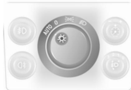
Commutateur d'éclairage positionné sur **AUTO** : Lorsque le moteur tourne, les feux de croisement s'allument en fonction des conditions de luminosité extérieures.
