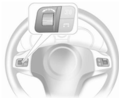
Les fonctions de l'Infotainment System et de l'Info-Display peuvent être commandées à partir du volant.
