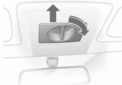
Pour ouvrir la garniture de toit : tourner la poignée vers la droite et déplacer la garniture de toit jusqu'à la position souhaitée.
