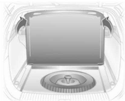
Prendre l'adaptateur et les crochets dans les rails des parois du coffre. Soulever les anneaux d'arrimage et lever le tapis de sol en position verticale de sorte qu'il repose sur la garniture de toit. Pour la fermeture, faire passer les anneaux d'arrimage dans les fentes du tapis de sol. Véhicules avec boîte de chargement : démontage ↻ 75.
