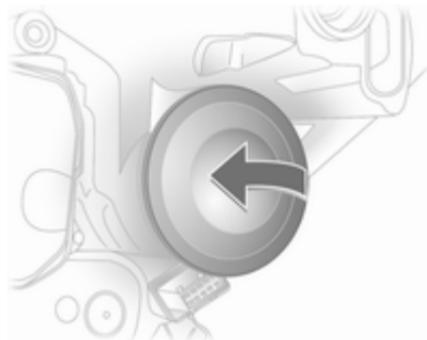
1. Effectuer le remplacement des ampoules par les ouvertures dans les passages de roue.
