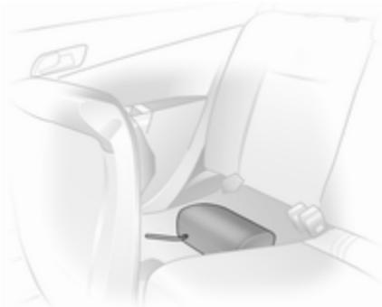
Retirer les appuis-tête extérieurs arrière et pousser l'appui-tête central jusqu'en bas ↻ 47. Ranger les appuis-tête dans la cavité sous les coussins de siège soulevés.
