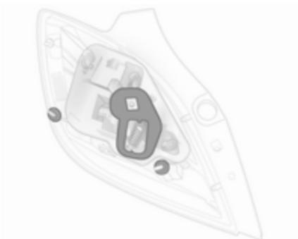
8. S'assurer que les joints sont présents sur la douille de l'ampoule et les vis de fixation.
