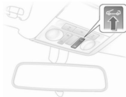
Aucun objet ne doit se trouver devant la lunette arrière ou dans la zone de rotation du toit et du couvercle de coffre.
