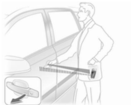
Avec la clé électronique, tirer simplement sur la poignée de la porte pour déverrouiller le véhicule et ouvrir la porte. Pour ouvrir le hayon, appuyer sur le bouton situé sous la moulure.
