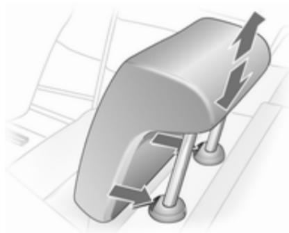
Tirer l'appui-tête vers le haut ou appuyer sur les deux loquets pour le déverrouiller, puis abaisser l'appui-tête.
