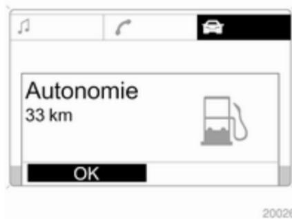
Si le niveau de carburant dans le réservoir est bas, le message **Autonomie** apparaît sur l'affichage.
