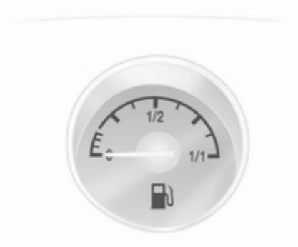
Affiche le niveau de remplissage de carburant dans le réservoir en fonction du mode de fonctionnement.
