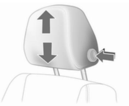
Appuyer sur le bouton de déverrouillage, régler la hauteur, verrouiller. Appuis-tête ↪ 47.
