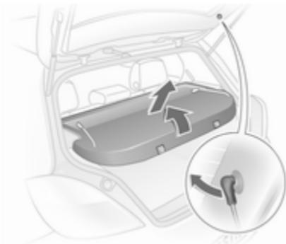
Décrocher les sangles de fixation du hayon. Tirer le cache des guides latéraux.
