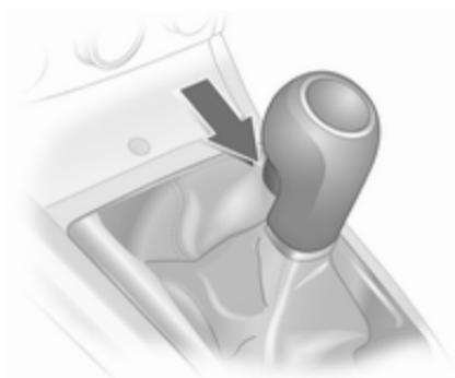
Marche arrière : lorsque le véhicule est à l'arrêt, soulever le bouton du levier sélecteur 3 secondes après avoir enfoncé la pédale d'embrayage et engager la marche arrière.
