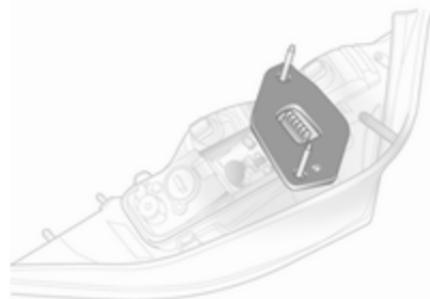
7. Replacer le joint sur la douille de l'ampoule. S'assurer que le joint est à plat autour des vis.
