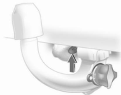
Verrouiller la barre d'attelage en tournant la clé en position (2). Enlever la clé et fermer le volet de protection.
