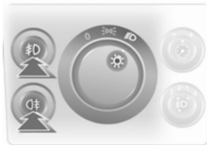
Les phares antibrouillard s'allument uniquement avec le contact mis et les feux de position ou les phares allumés.
