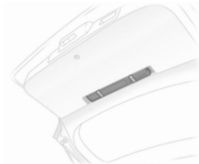
Mettre le triangle de présignalisation dans l'espace du hayon et le fixer avec les sangles droite et gauche.
