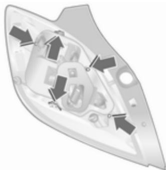
5. Déposer le joint du boulon de fixation. Écarter les pattes de verrouillage à l'extérieur de la douille de l'ampoule et enlever l'ampoule.
