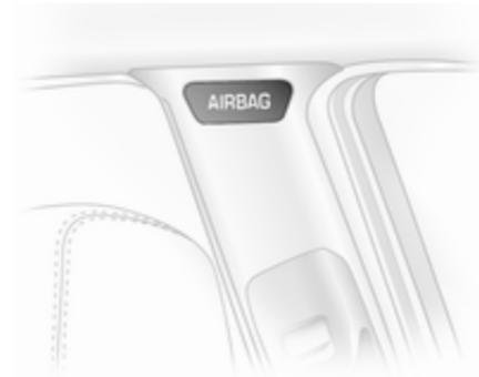
Le système d'airbags rideaux se compose d'un airbag de cadre de toit, de chaque côté du véhicule. Ceci est reconnaissable aux inscriptions **AIRBAG** sur les montants de toit.
