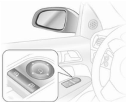
Commencer par sélectionner le rétroviseur extérieur souhaité, puis basculer la commande pour le régler.
