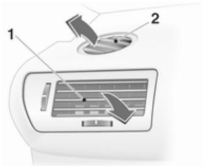
Régler la direction du flux d'air en faisant basculer et pivoter les lamelles. Pour fermer la bouche d'aération, tourner la molette vers **O**.
