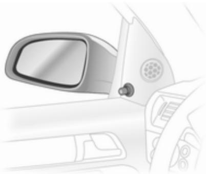
Régler les rétroviseurs en faisant pivoter le levier dans la direction souhaitée.
