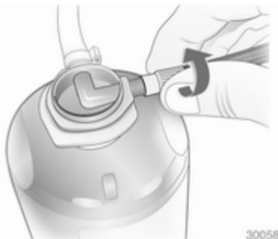
4. Visser le flexible d'air du compresseur sur le raccord de la bouteille de produit d'étanchéité.
