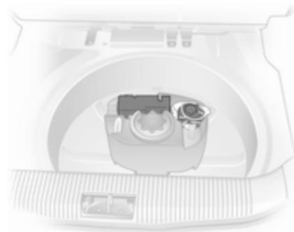
Le kit de réparation des pneus se trouve dans le compartiment sous le tapis de sol du coffre.
