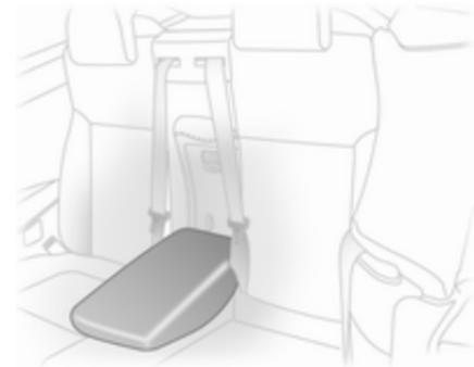
Tirer l'accoudoir par la sangle, le faire pivoter vers le bas et le placer sur le siège avec le côté plat vers le haut.
