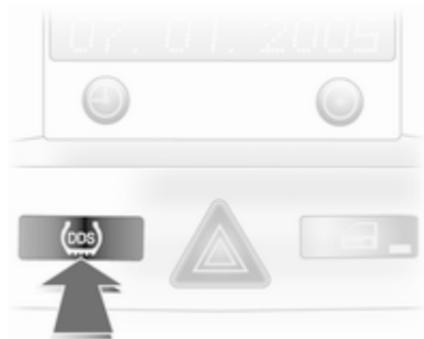
Après un changement de roue, le système doit être initialisé : gonfler les pneus à la pression prescrite, mettre le contact, appuyer sur le bouton **DDS** et le maintenir enfoncé pendant 4 secondes environ, le témoin (⚠) clignote trois fois.
