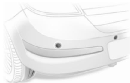
L'aide au stationnement facilite les manœuvres en mesurant la distance entre le véhicule et les obstacles. C'est toutefois le conducteur qui reste pleinement responsable du stationnement.
