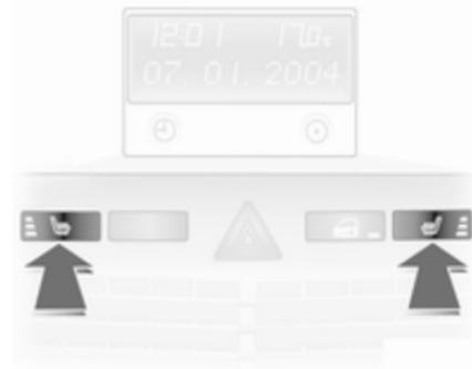
En fonction du niveau de chauffage voulu, appuyer une ou plusieurs fois sur le bouton
