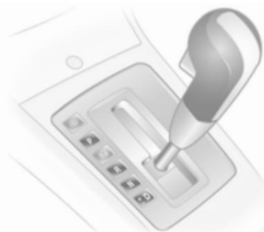
Le levier sélecteur ne peut quitter la position **P** ou **N** que si le contact est mis et si la pédale de frein est enfoncée (verrouillage du levier sélecteur). Quand le levier sélecteur est en position **N**, le verrouillage de levier sélecteur est actionné après un certain temps et uniquement si le véhicule est à l'arrêt.
