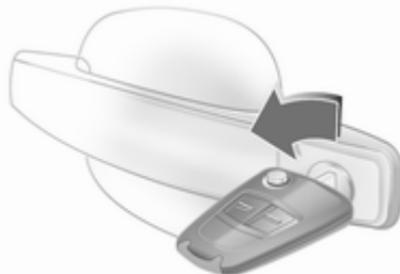
Tourner au maximum la clé ou la clé de secours
