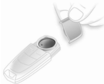
Pour remplacer la pile, appuyer sur le mécanisme de verrouillage et enlever le capuchon en exerçant une légère pression. Appuyer de l'autre côté du capuchon vers l'extérieur.
