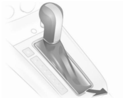
Si la batterie n'est pas la cause du défaut, déverrouiller le levier sélecteur :
