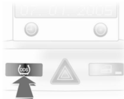
Après une correction de la pression de gonflage ou un changement de roue, il faut initialiser le système : mettre le contact, enfoncer et maintenir le bouton **DDS** pendant 4 secondes environ, le témoin (⚠) clignote trois fois.
