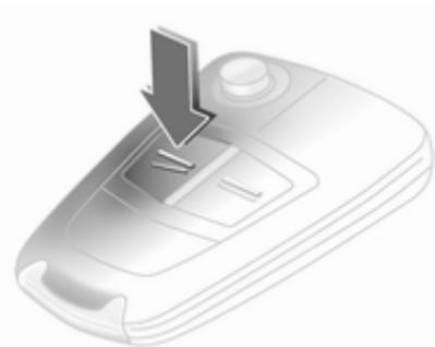
Lorsque les portes sont fermées à l'aide du verrouillage central, il est impossible d'ouvrir le couvercle de coffre avec le bouton
