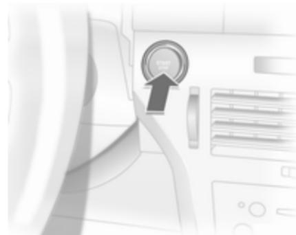
Appuyer sur le bouton **Start/Stop**. Le contact est mis. Le blocage électronique du démarrage et le blocage de la direction sont désactivés.
