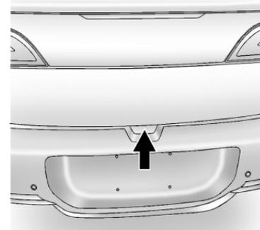
Pour ouvrir le hayon lorsque toutes les portes sont déverrouillées, appuyer sur le bouton situé sous la poignée du hayon et soulever.
