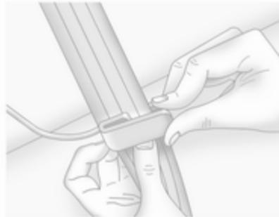
2. Placer le guide sur la ceinture et insérer les deux bords de la ceinture de sécurité dans les fentes du guide.
