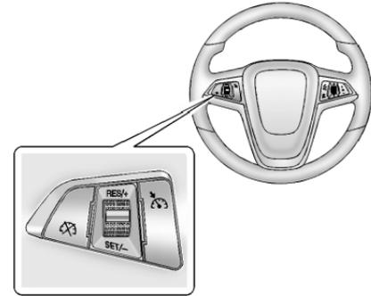
L'Infotainment System et le régulateur de vitesse peuvent être commandés via les organes de commande placés sur le volant.
