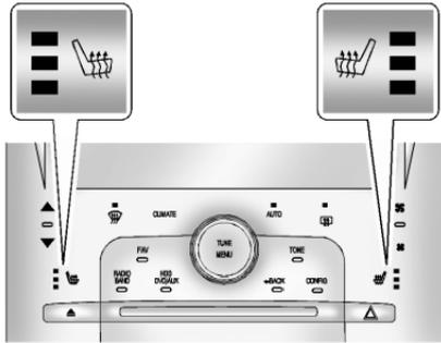
En fonction du niveau de chauffage voulu, appuyer une ou plusieurs fois sur le bouton du siège respectif. Les diodes placées à côté du symbole de chauffage indiquent le réglage.
