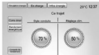
On accède à cet écran en appuyant sur **Rendement énergétique** sur l'écran **Cons éner**. Cet écran affiche l'efficacité énergétique au cours du cycle de conduite sur base du style de conduite et des réglages de la climatisation. Conduire de manière plus efficace augmentera le pourcentage relatif au cycle de conduite. Minimiser l'utilisation du système de climatisation augmentera le pourcentage relatif au réglage de la climatisation.
