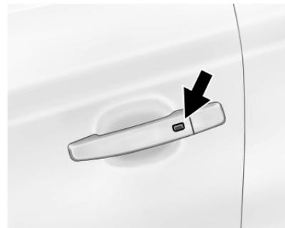
Lorsque la télécommande radio se trouve à portée de fonctionnement, appuyer simplement sur le bouton de verrouillage/déverrouillage de la poignée de porte pour déverrouiller la porte du conducteur.
