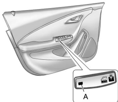
Appuyer sur le commutateur
