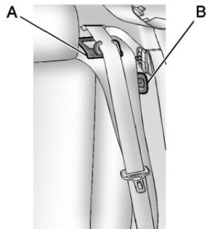
3. Retirer la ceinture de sécurité du guide de ceinture de sécurité (A) et la placer dans l'agrafe de rangement.
