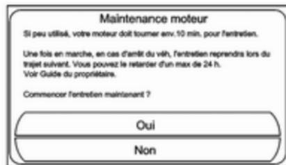
Si **Oui** est sélectionné, le mode de maintenance du moteur sera initié. Le moteur fonctionnera sans coupure pendant une durée déterminée. En cours du mode de maintenance du moteur, un message du DIC affiche un pourcentage d'exécution de ce mode.
