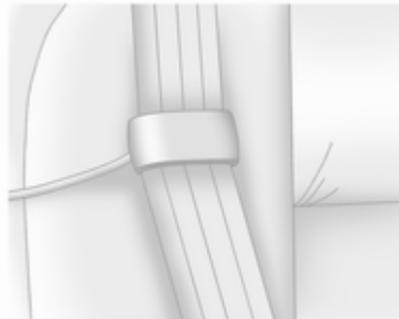
3. La ceinture de sécurité ne doit pas être tordue et doit reposer à plat. Le cordon élastique doit être sous la ceinture de sécurité et le guide par-dessus.
