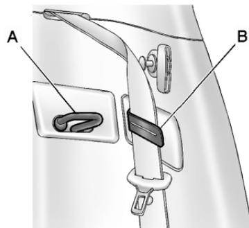
1. S'assurer que les ceintures de sécurité soient dans l'agrafe de rangement (B) avant de redresser le dossier de siège.
