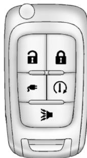
Appuyer sur le bouton
