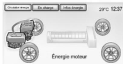
**Énergie moteur** - Le moteur est actif et l'énergie est transmise aux roues.
