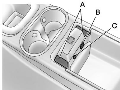
À l'intérieur de l'avant de la console de plancher se trouve une prise d'alimentation auxiliaire (C) et une prise pour des dispositifs d'entrée auxiliaires (B). Les cordons peuvent être acheminés par le passage (A).
