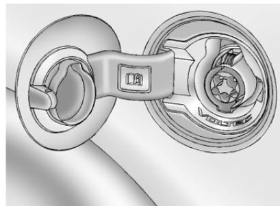
4. Brancher la fiche véhicule du cordon de chargement dans la prise de charge du véhicule. Vérifier si l'indicateur d'état de chargement du véhicule s'allume au sommet du tableau de bord et si un signal de l'avertisseur sonore est émis. État du chargement ⇨ 138.
