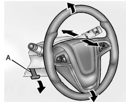
Débloquer le levier (A), régler le volant, puis engager le levier et vérifier qu'il est bien verrouillé.
