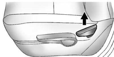
Tirer le levier, régler l'inclinaison et relâcher le levier. Laisser le dossier s'encliqueter de manière audible.
