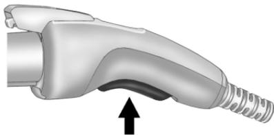
2. Débrancher la fiche véhicule du cordon de chargement du véhicule en pinçant le levier de la fiche véhicule et en tirant pour la retirer.
