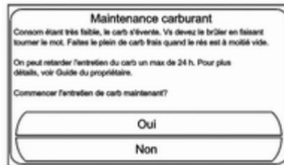
Si **Oui** est sélectionné, le mode de maintenance du carburant sera initié. Le mode de maintenance du carburant se poursuivra automatiquement à chaque démarrage du véhicule jusqu'à l'ajout de carburant frais.
