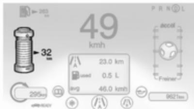
Cet indicateur affiche le niveau de charge de la batterie haute tension.
