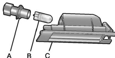
3. Tourner la douille de l'ampoule (A) dans le sens antihoraire pour la déposer de l'ensemble de feux (C).
