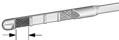
Si le niveau d'huile moteur est sous la section hachurée du bout de la jauge, ajouter de l'huile moteur.
