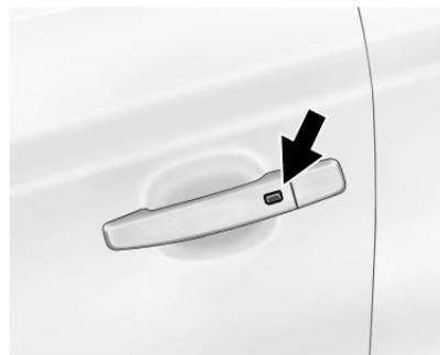
Pour déverrouiller la porte sur la porte du conducteur, appuyer sur le bouton de verrouillage/déverrouillage de la poignée de porte.
