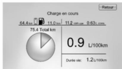
Les informations d'utilisation de l'énergie apparaîtront automatiquement lors de la coupure du contact quand la prolongation de l'alimentation est active. Cette fenêtre automatique peut être désactivée via la personnalisation du véhicule.
