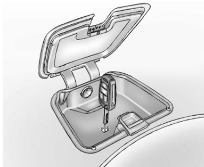
2. Étendre la lame de clé et placer la lame dans la fente.
