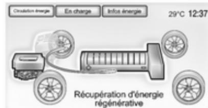
**Récupération d'énergie régénérative** - L'énergie provenant des roues revient vers la batterie au cours d'un freinage ou d'un déplacement en roue libre régénératif.
