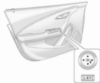
Sélectionner le rétroviseur extérieur souhaité en déplaçant le commutateur vers la gauche (L) ou vers la
