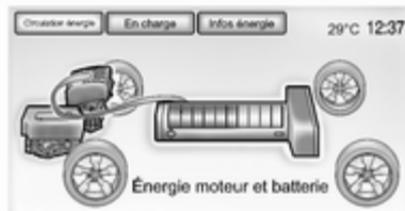
**Énergie moteur et batterie** - Le moteur et la batterie sont tous deux actifs et l'énergie est transmise aux roues.
