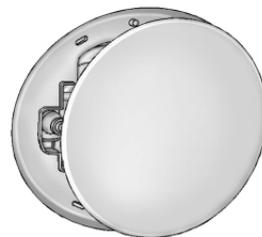
2. Lorsqu'un message s'affiche dans le DIC indiquant que le système est prêt à être rempli, la trappe à carburant du côté passager se déverrouille. Enfoncer le bord arrière de la trappe à carburant et relâcher pour ouvrir la trappe.
