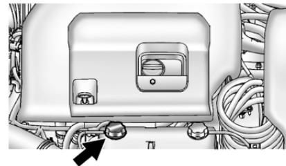
Vérifier si le liquide de refroidissement est visible dans le réservoir de liquide de refroidissement de la batterie haute tension. Si le liquide de refroidissement est visible mais que le niveau de liquide de refroidissement se trouve en-dessous de la ligne de remplissage à froid, il se peut qu'il y ait une fuite dans le système de refroidissement.
