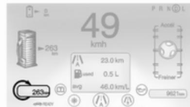
L'autonomie totale du véhicule est la distance restante que peut parcourir le véhicule en combinant l'autonomie électrique et l'autonomie du carburant.
