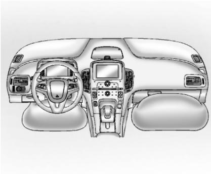
En cas d'airbags de genoux, le mot **AIRBAG** figurera sur la partie inférieure du tableau de bord.
