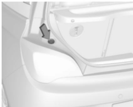
Monter l'ensemble du feu avec les goupilles de retenue dans les renforcements de la carrosserie et visser l'écrou de fixation par l'intérieur du coffre. Tirer le joint circulaire au-dessus du logement dans le boîtier de phare.
