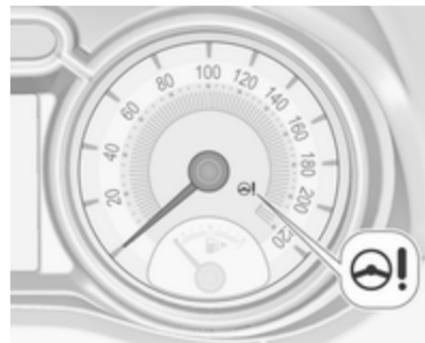
En cas de défaillance dans le système,
