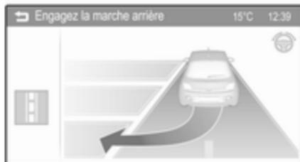
Le système est configuré pour rechercher des emplacements de parking, par défaut, du côté passager. Pour détecter des emplacements de parking côté conducteur, activer le clignotant côté conducteur pendant toute la durée de la recherche.
