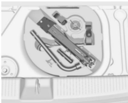
Le cric, la clé de roue, les outils et deux sangles de retenue de la roue endommagée se trouvent dans la boîte à outils sous le tapis de sol du coffre ➔ 67.
