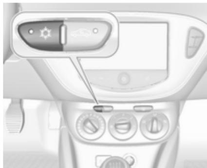
Appuyer sur le bouton ☀ pour mettre le refroidissement en marche. L'activation est signalée par la LED dans le bouton.
