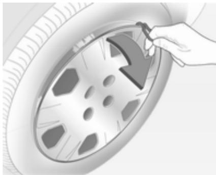
1. Dégager et retirer les capuchons des vis de roue à l'aide d'un tournevis. Enlever l'enjoliveur à l'aide du crochet. Outillage de bord ⇨ 183.
