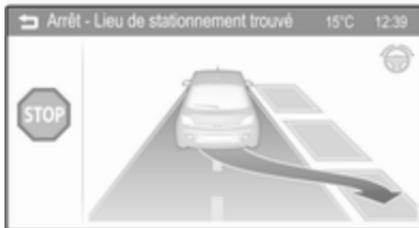
Si le conducteur n'arrête pas le véhicule dans les 10 mètres pour un stationnement en créneau ou dans les 6 mètres pour un stationnement perpendiculaire après la suggestion d'un emplacement de parking, le système commence à chercher un autre emplacement de parking adéquat.
