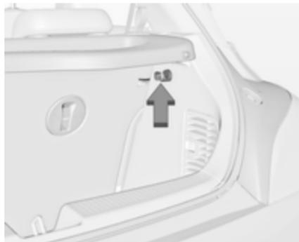
Utiliser le crochet sur la paroi latérale droite du coffre pour accrocher les sacs-coches. Charge maximale : 5 kg
