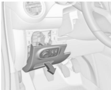
Dans les véhicules avec direction à gauche, la boîte à fusibles se trouve derrière le commutateur d'éclairage du tableau de bord.
