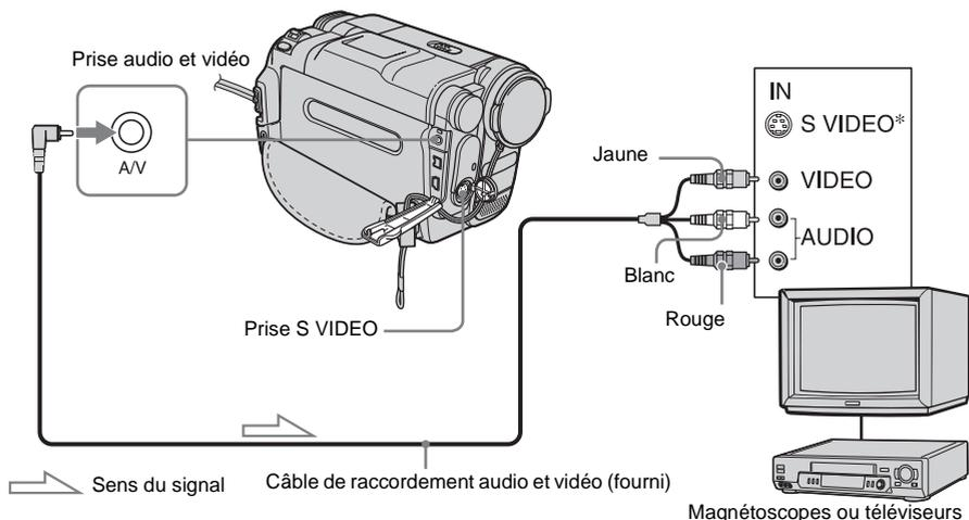
\* Les images peuvent être reproduites avec plus de fidélité à l'aide du câble S-vidéo (en option). Si l'appareil est doté d'une prise S-vidéo à raccorder, branchez la fiche S-vidéo à cette prise au lieu d'utiliser la fiche vidéo jaune. Le son n'est pas émis lorsque vous effectuez un raccordement avec la fiche S-vidéo uniquement.
