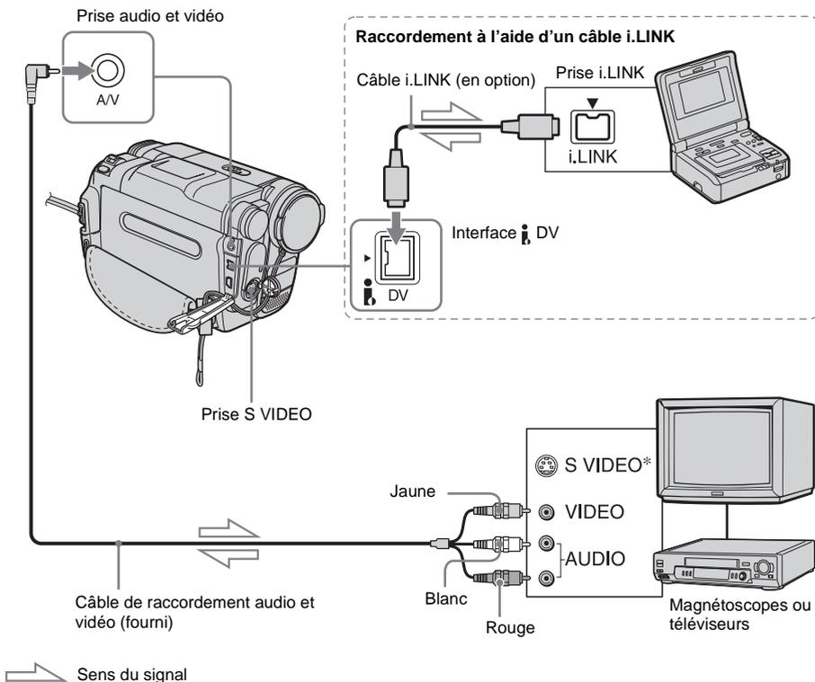
\* Les images peuvent être reproduites avec plus de fidélité à l'aide du câble S-vidéo (en option). Si l'appareil est doté d'une prise S-vidéo à raccorder, branchez la fiche S-vidéo du câble de raccordement audio et vidéo à cette prise au lieu d'utiliser la fiche vidéo jaune. Le son n'est pas émis lorsque vous effectuez un raccordement avec la fiche S-vidéo uniquement.
