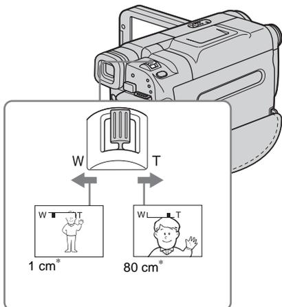
\* Distance minimale nécessaire entre votre caméscope et le sujet afin d'obtenir une mise au point nette, lorsque la manette est dans cette position.
