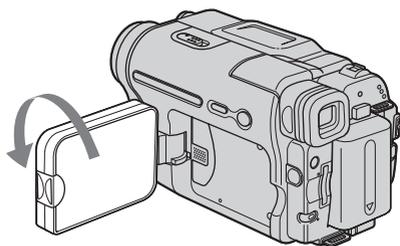
**Ouvrez le panneau LCD à 90° vers le caméscope, puis faites-le pivoter à 180° vers le sujet.**
