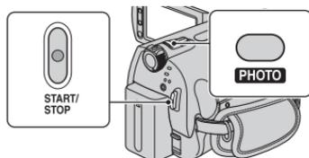
① Tournez le commutateur POWER jusqu'à ce que le témoin (Film) s'allume, puis appuyez sur START/STOP pour démarrer l'enregistrement d'un film.
