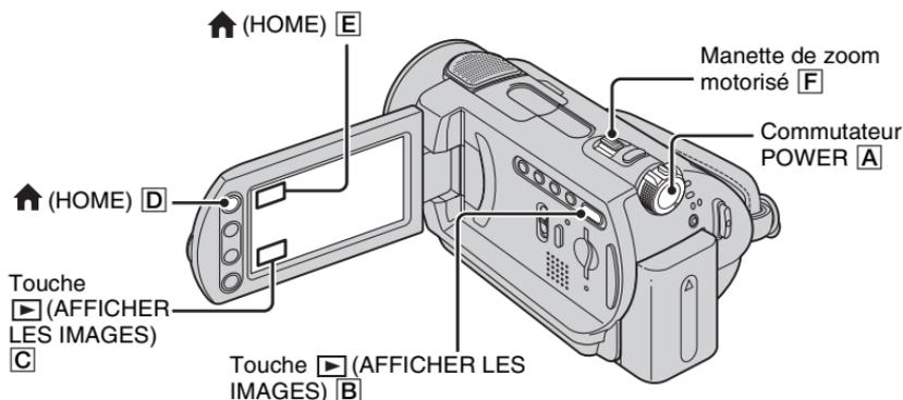
**1** Tournez le commutateur POWER **A** pour mettre le caméscope sous tension.
