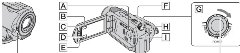
Ouvrez le capuchon d'objectif (DCR-SR32E/SR33E/ SR42E/SR52E/SR62E/SR72E/SR82E) (p. 19) Si le commutateur POWER est réglé sur OFF (CHG), tournez-le tout en appuyant sur le bouton vert.
