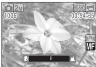
**2** Appuyez sur **[◀]** ou **[▶]** pour régler la distance de mise au point, puis appuyez sur le bouton de réglage **SET**.
