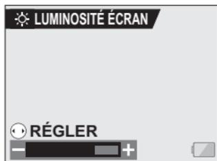
**3** Déplacez le bouton de réglage SET vers la gauche ou la droite pour régler la luminosité et appuyez sur le bouton de réglage SET.
