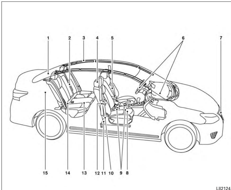
1. Ancrage de la courroie supérieure
