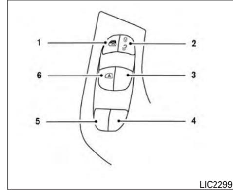
1. Interrupteur de verrouillage des glaces
