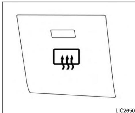
Pour dégivrer la lunette arrière (rear) et les rétroviseurs extérieurs (selon l'équipement), démarrez le moteur et appuyez sur l'interrupteur de dégivreur de lunette arrière (rear). Le témoin de dégivreur de lunette arrière qui se trouve sur l'interrupteur s'allume. Appuyez de nouveau sur l'interrupteur pour mettre le dégivreur hors fonction.
