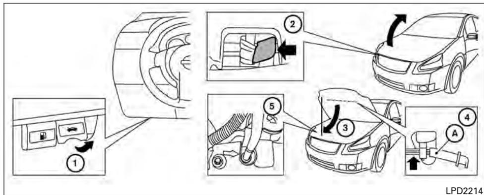
1. Tirez la poignée de déverrouillage du verrou du capot ① sous le tableau de bord jusqu'à ce que le capot se soulève légèrement.
