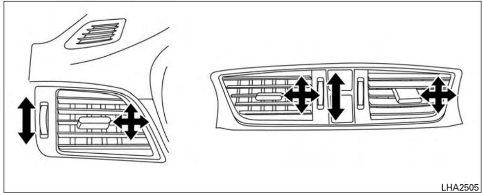
Déplacez les grilles orientables des bouches d'air pour régler la direction de l'air.
