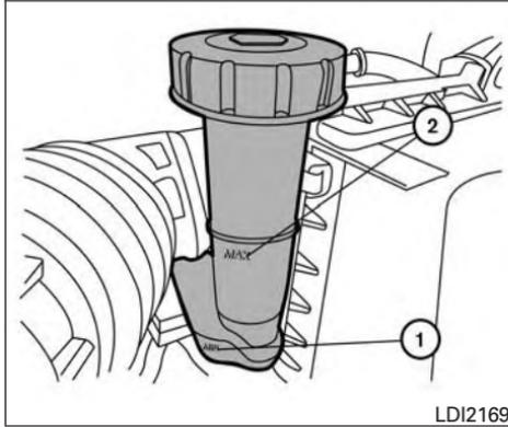
Vérifiez le niveau du liquide dans le réservoir. Si le niveau est inférieur au repère MIN ① ou si le témoin du système de freinage s'allume, ajoutez du liquide de frein d'origine NISSAN ou du liquide **DOT 3** équivalent jusqu'au repère MAX ②. Faites vérifier le circuit d'embrayage de votre véhicule chez un concessionnaire NISSAN si vous devez y ajouter fréquemment du liquide de frein.
