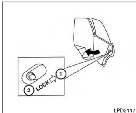
Lorsque le levier est en position **LOCK** (antivol-verrouillé) ①, la portière ne peut être ouverte que de l'extérieur.
