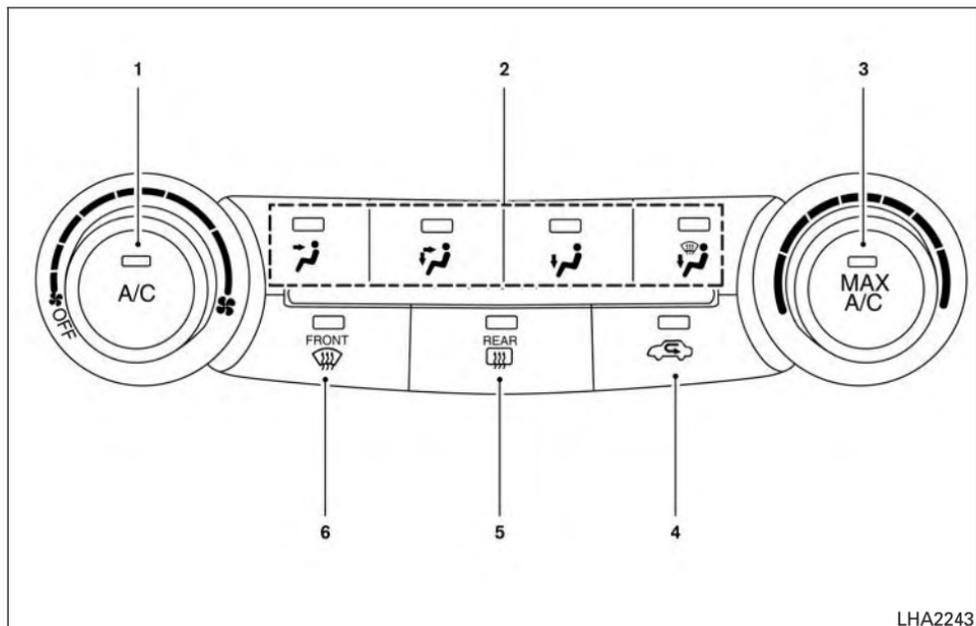
1. Commande de vitesse du ventilateur/arrêt du système/touche A/C de climatisation (selon l'équipement)
