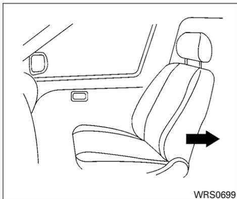
1. **Si vous devez installer un siège d'appoint sur le siège avant, déplacez le siège aussi loin que possible vers l'arrière.**
