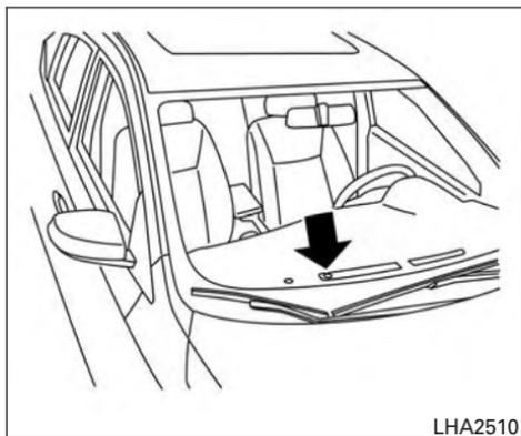
Le capteur d'ensoleillement (selon l'équipement), situé sur le dessus du tableau de bord du côté passager, favorise le maintien d'une température constante. Ne déposez rien sur le capteur ou à proximité de celui-ci.
