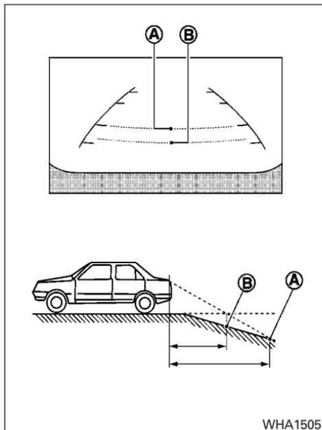
affiche qu'il y a 1,0 m (3 pi) jusqu'au plan (A) mais la distance réelle de 1,0 m (3 pi) dans la pente se situe au plan (B). Notez que les objets qui apparaissent à l'écran sont en réalité plus près sur la pente.
