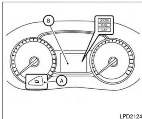
**Message d'avertissement LOOSE FUEL CAP (bouchon de réservoir de carburant desserré)**
