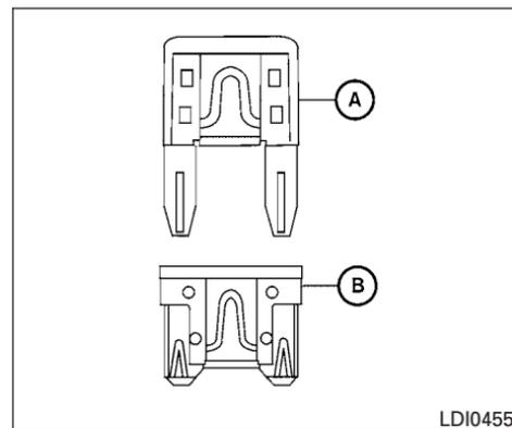
Votre véhicule utilise deux types de fusibles. Les boîtes à fusibles du compartiment moteur utilisent des fusibles de type **(A)**. La boîte à fusibles de l'habitacle utilise des fusibles de type **(B)**.
