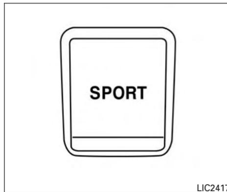
Ajustez la sensibilité de l'accélérateur et les changements de vitesse programmés (transmission à variation continue seulement) pour optimiser le rendement. Appuyez sur la touche SPORT du tableau de bord pour l'activer. Le témoin de mode SPORT (sur le compteur de vitesse) s'allume. Le témoin de mode SPORT reste allumé pendant que le mode est activé.
