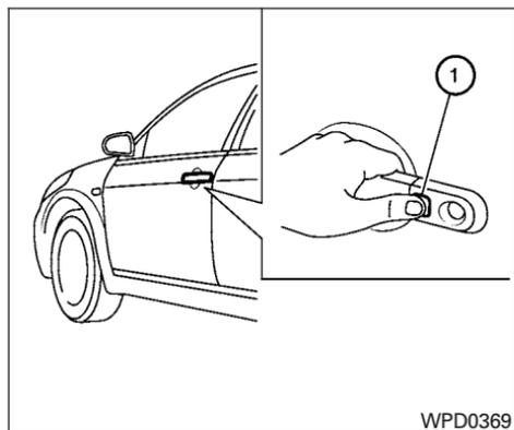
Si une poignée de portière est tirée pendant le déverrouillage des portières, cette portière peut ne pas se déverrouiller. Remettez la poignée de portière à sa position d'origine pour déverrouiller la portière. Si la portière ne se déverrouille pas lorsque la poignée de portière revient à sa position d'origine, enfoncez le commutateur de demande de poignée de portière pour déverrouiller la portière.
