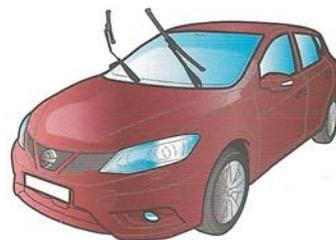
Pour nettoyer ou remplacer les balais d'essuie-glace, levez les bras de l'essuie-glace du pare-brise, et laissez-les en position droite.
