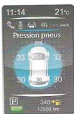
Le système de contrôle de pression des pneus (TPMS) contrôle continuellement la pression des pneus par rapport aux pressions cibles paramétrées. Si la pression d'un ou de plusieurs pneus diffère significativement de la pression cible, le système de contrôle de pression des pneus envoie un avertissement sur l'écran d'informations du véhicule et le témoin d'avertissement s'allume sur le combiné d'instruments.
