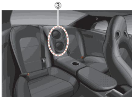
Ce système utilise les microphones avant et arrière ① pour détecter les bruits de grondement du moteur. Le système génère alors automatiquement un son d'annulation de bruit via les haut-parleurs ② et le woofer ③ pour réduire les bruits de grondement du moteur.
