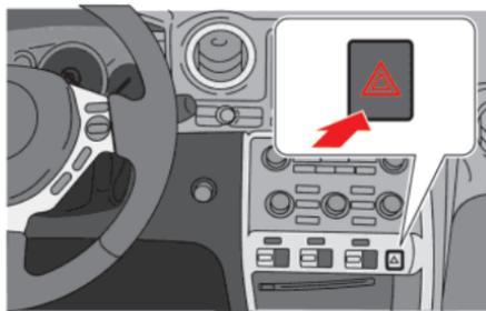
Appuyez sur l'interrupteur pour avertir les autres usagers de la route lorsque le véhicule doit être immobilisé en cas d'urgence. Tous les clignotants fonctionnent simultanément.
