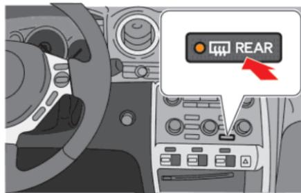
Pour désembuer ou dégivrer la lunette arrière, démarrez le moteur et appuyez sur la commande. Le témoin indicateur sur la commande s'allume. Appuyez de nouveau sur la commande pour arrêter le dégivreur.
