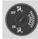
Insérer la clé intégrée et, le cas échéant, appuyer dessus.
