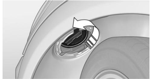
4. Tourner l'ampoule dans le sens antihoraire et la retirer.
