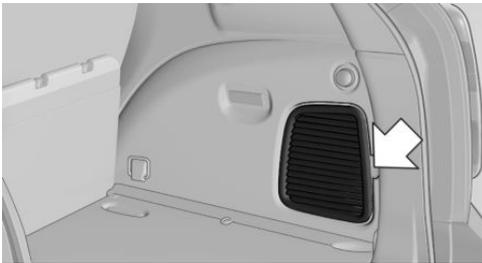
4. Décrocher le dispositif de déverrouillage de secours de la trappe du réservoir, voir page 166, et le pousser de côté avec la mousse.
