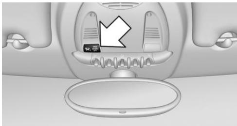
Le témoin des airbags du passager avant montre l'état de fonctionnement des airbags du passager avant.
