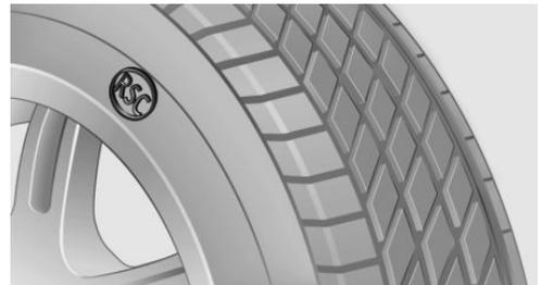
Vous pouvez reconnaître les pneus permettant de rouler à plat par le symbole circulaire avec les lettres RSC situé sur le flanc du pneu.
