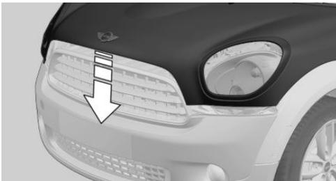
Fermer le capot moteur d'une hauteur d'env. 40 cm avec élan. Il doit s'enclencher avec un déclic nettement audible.
