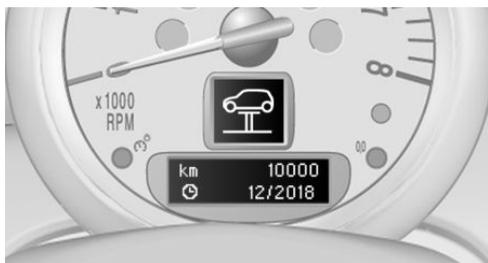
Le système d'entretien MINI vous indique les mesures de maintenance à prendre afin de garantir la fiabilité et la sécurité routière du véhicule.
