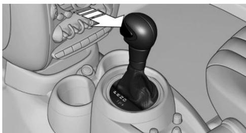
Un dispositif de blocage empêche un passage par erreur sur les positions du levier sélecteur R et P.
