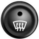
Le givre et la buée déposés sur le pare-brise et les vitres latérales avant disparaissent rapidement. Pour cela, activer aussi la fonction de refroidissement.
