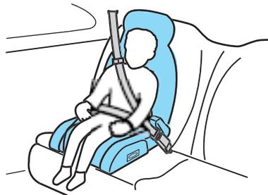
Les deux types de rehausseur peuvent être utilisés dans un véhicule sur un siège doté d'une ceinture trois points si l'enfant pèse plus de 18 kg (40 lb).
