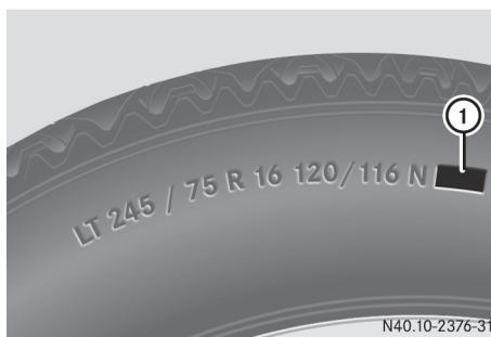
En plus de l'indice de charge, un code de charge ① peut être inscrit sur le flanc du pneu, après la lettre indiquant l'indice de vitesse (▷ page 281).
