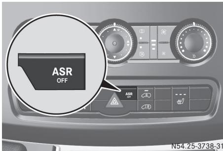
Lorsque l'ESP® intervient et que le voyant d'alerte
