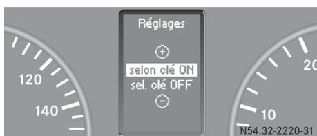
La fonction **Réglages** vous permet de déterminer si les réglages effectués dans certains sous-menus doivent être mémorisés en fonction de la clé.
