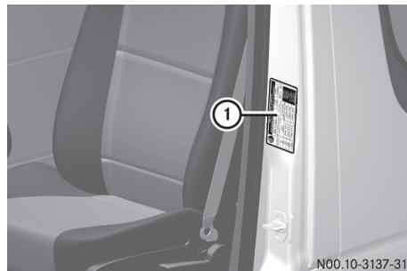
Plaque d'information sur les pneus et le chargement située sur le montant B côté conducteur
