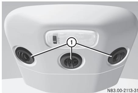
Dans le cas des véhicules équipés d'un climatiseur arrière, des buses de ventilation réglables sont intégrées au toit, dans le canal d'air.
