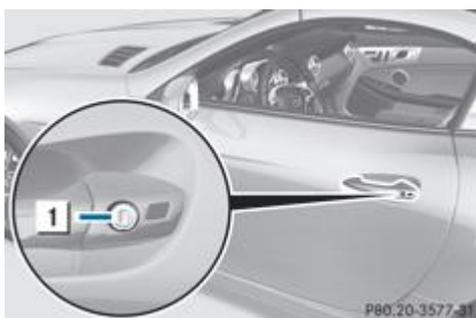
► Tournez la clé de secours dans le sens inverse des aiguilles d'une montre en position **1**.
