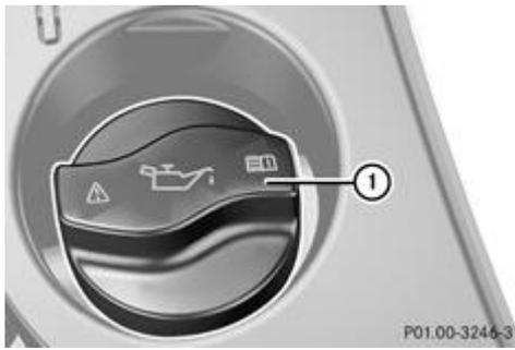
P01.00-3244-31 Bouchon du réservoir d'huile moteur (exemple)
