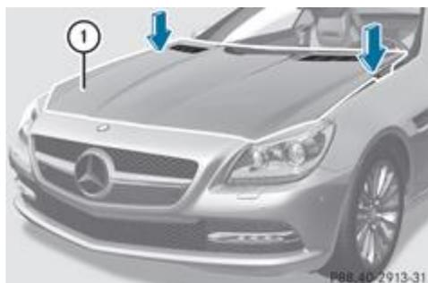
► Appuyez sur le capot actif ① avec le plat de la main au niveau des charnières (flèches) jusqu'à enclenchement.
