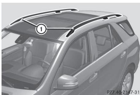
► Fixez le système de portage aux rampes de toit ①. Suivez pour cela les instructions de montage du fabricant.
