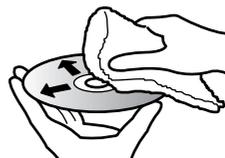
Se servir d'un morceau d'étoffe souple pour nettoyer en agissant de l'intérieur vers l'extérieur et dans le sens axial.
