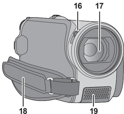
**16** Commutateur ouverture/fermeture du couvre objectif
