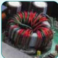
Transformateur à bobine toroïdale en parallèle
