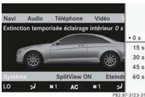
► **Réglage de l'extinction temporisée de l'éclairage intérieur/extérieur** : poussez et tournez le sélecteur COMAND pour sélectionner *Véhicule* sur la ligne des fonctions principales, puis appuyez dessus pour confirmer. La zone principale est activée.
