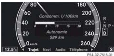
L'autonomie approximative est déterminée sur la base de la quantité de carburant restant dans le réservoir et de votre style de conduite. S'il ne reste presque plus de carburant dans le réservoir, l'autonomie approximative est remplacée par un symbole représentant un véhicule en ravitaillement
