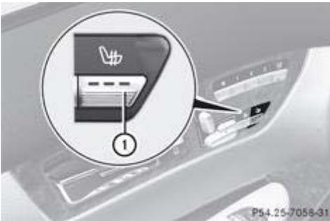
Le chauffage passe automatiquement du niveau **3** au niveau **2** au bout de 8 minutes environ.
