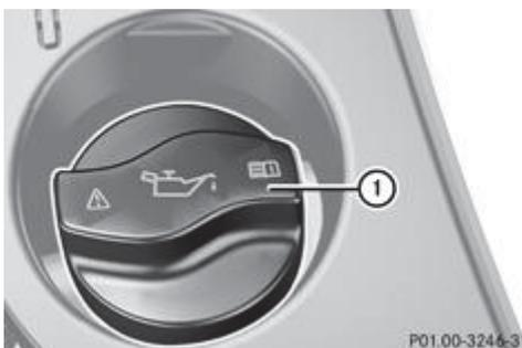
P01.00-3244-31 Bouchon du réservoir d'huile moteur (exemple)
