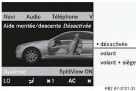
► **Réglage de l'aide à la montée et à la descente** : poussez et tournez le sélecteur COMAND pour sélectionner *Véhicule* sur la ligne des fonctions principales, puis appuyez dessus pour confirmer. La zone principale est activée.
