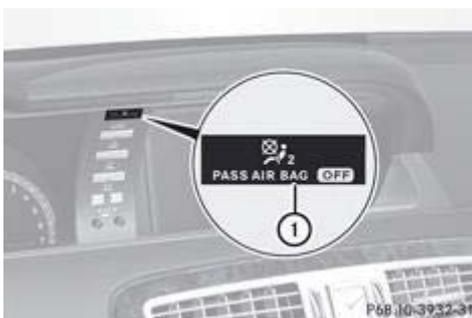
Le système de capteurs de détection automatique de siège-enfant sur le siège du passager détecte la présence d'un siège-enfant Mercedes-Benz spécial doté de transpondeurs pour la détection automatique de siège-enfant. Dans ce cas, le voyant PASSENGER AIRBAG OFF
