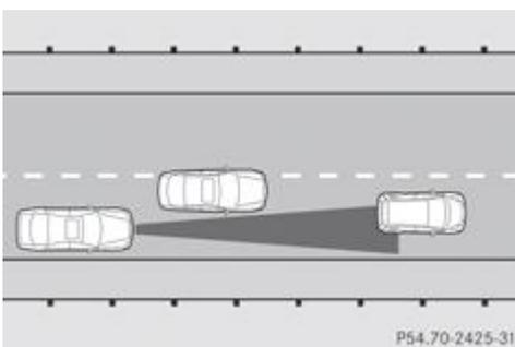
Le DISTRONIC PLUS peut ne pas détecter les véhicules dont la trajectoire est décalée. Dans ce cas, la distance par rapport au véhicule qui précède sera trop faible.
