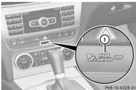
Le système de capteurs de détection automatique de siège-enfant sur le siège du passager détecte la présence d'un siège-enfant Mercedes-Benz spécial doté de transpondeurs pour la détection automatique de siège-enfant. Dans ce cas, le voyant PASSENGER AIRBAG OFF
