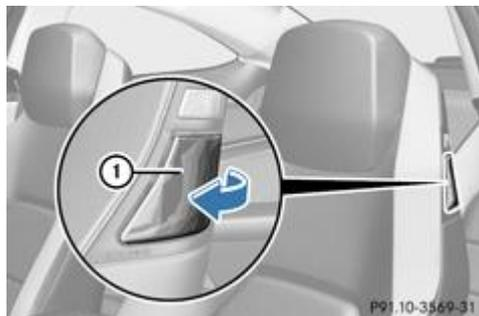
► **Véhicules sans fonction Mémoires** : déverrouillez l'appuie-tête si nécessaire et abaissez-le.
