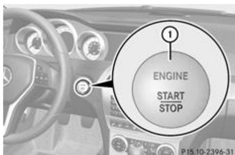
► Position **0** : tant que la touche de démarrage et d'arrêt **1** n'a pas été actionnée, l'électronique de bord se trouve dans la position qui correspond à « clé retirée ».
