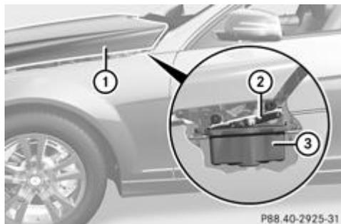
En cas de déclenchement du capot actif <sup>①</sup>, la partie arrière du capot se soulève de 50 mm environ. Les couvercles <sup>②</sup> ne reposent alors plus sur les boîtiers <sup>③</sup>.
