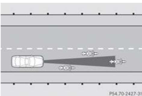
Le DISTRONIC PLUS ne détecte pas les véhicules qui se trouvent sur les bords de la voie empruntée en raison de leur largeur réduite. Dans ce cas, la distance par rapport au véhicule qui précède sera trop faible.
