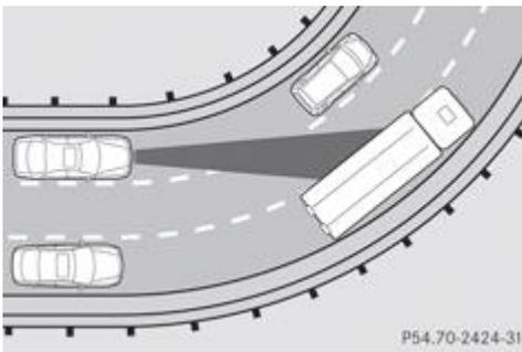
Dans les virages, le DISTRONIC PLUS ne peut détecter les véhicules que de façon limitée. Il peut alors freiner le véhicule inopinément ou avec retard.
