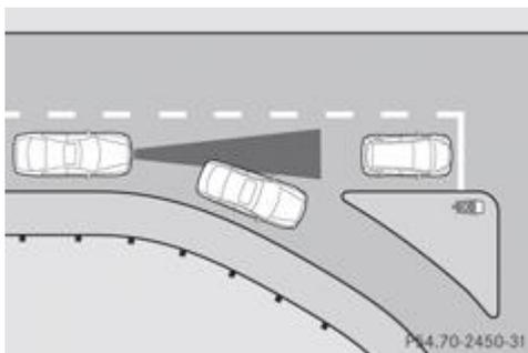
Le DISTRONIC PLUS ne freine pas en présence d'obstacles ou de véhicules à l'arrêt. Lorsque, par exemple, le véhicule détecté tourne et qu'un obstacle ou un véhicule à l'arrêt se présente, le DISTRONIC PLUS ne freine pas.
