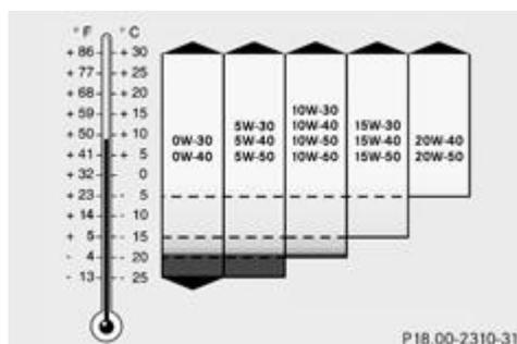
La viscosité désigne la fluidité d'un liquide. Dans le cas de l'huile moteur, une viscosité élevée indique une huile épaisse et une faible viscosité une huile légère.
