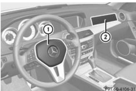
L'airbag frontal du conducteur ① se déploie devant le volant, l'airbag frontal du passager ② devant et au-dessus de la boîte à
