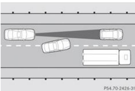
Le DISTRONIC PLUS ne détecte pas immédiatement les véhicules qui changent de voie. La distance par rapport au véhicule qui change de voie sera trop faible.
