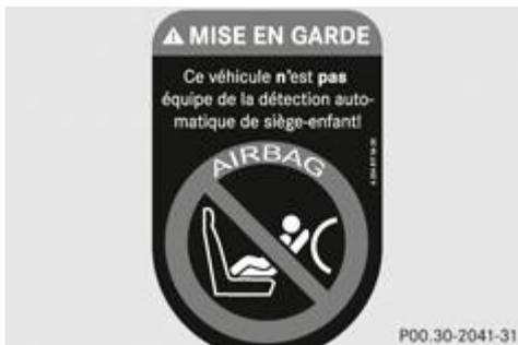
Si votre véhicule n'est pas équipé de la détection automatique de siège-enfant <sup>[1]</sup> au niveau du siège du passager, cela est signalé par un autocollant spécial. Cet autocollant est apposé à l'extrémité de la planche de bord côté passager. Il est visible lorsque vous ouvrez la porte du passager.
