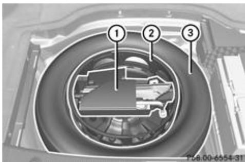
► **Extraction de la roue de secours normale ou de la roue de secours compacte « Minispare »** : retirez la trousse de l'outillage ①.
