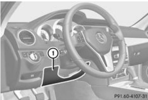
L'airbag de genoux côté conducteur <sup>①</sup> se déclenche toujours en même temps que l'airbag frontal du conducteur et se déploie en dessous de la colonne de direction.
