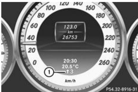
► Engagez le rapport indiqué lorsque la recommandation de changement de rapport correspondante ① apparaît sur le visuel multifonction du combiné d'instruments.
