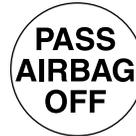
est neutralisé. Le témoin se trouve sur le tableau de bord, à droite de la radio.
