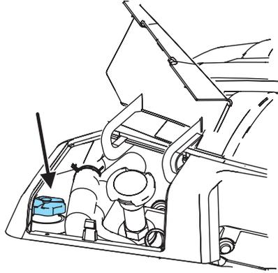
4. Vérifiez le niveau du liquide dans le réservoir. Il devrait se situer entre les repères MIN et MAX. N'ajoutez pas de liquide si le niveau se situe dans cette plage.
