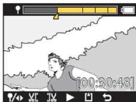
**4** Utilisez ▲▼ pour sélectionner le point d'arrivée de la vidéo à extraire, puis appuyez sur la commande OK.
