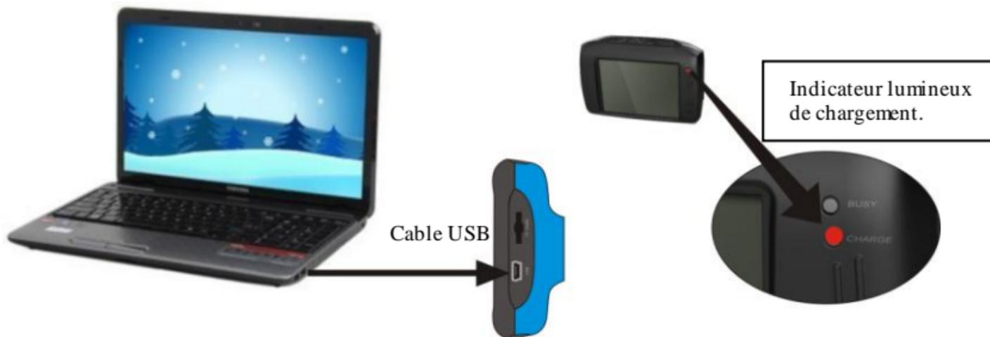
Connectez la caméra à l'ordinateur pour le chargement en mode éteint. L'indicateur lumineux pour le chargement s'allume alors et s'éteindra lorsque le chargement sera terminé. En général, l'appareil peut se charger complètement en 2-4 heures.
