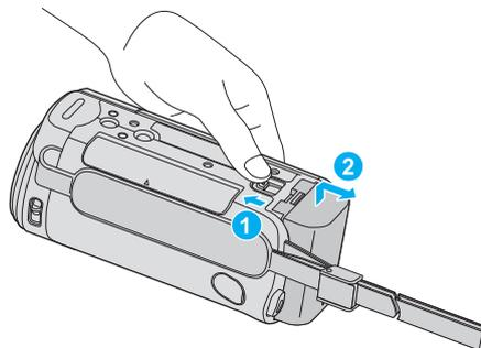
Faites coulisser le levier de dégagement de la batterie pour la détacher de l'appareil.
