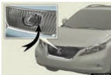
Le capteur radar détecte les véhicules ou autres obstacles sur la route ou à ses abords, et détermine l'imminence d'une collision en fonction de la position, de la vitesse et de la trajectoire des obstacles.
