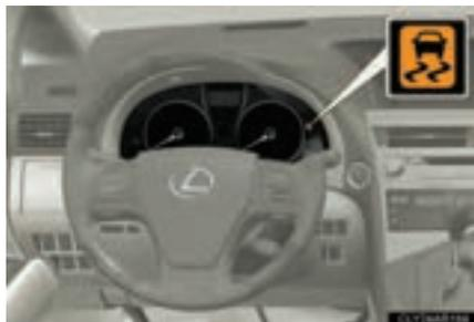
Si le véhicule risque de déraiper ou de reculer en démarrage en côte, ou si une roue motrice patine, le témoin de perte d'adhérence clignote pour indiquer l'intervention des systèmes VSC/TRAC.
