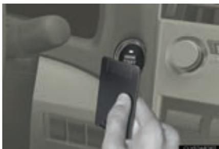
**ÉTAPE 3** Pour changer le mode du bouton de démarrage/d'arrêt moteur "ENGINE START STOP": Dans les 10 secondes qui suivent le déclenchement du signal sonore, relâchez la pédale de frein et appuyez sur le bouton de démarrage/d'arrêt moteur "ENGINE START STOP". Chaque appui sur le bouton permet de changer de mode. (→P.171)
