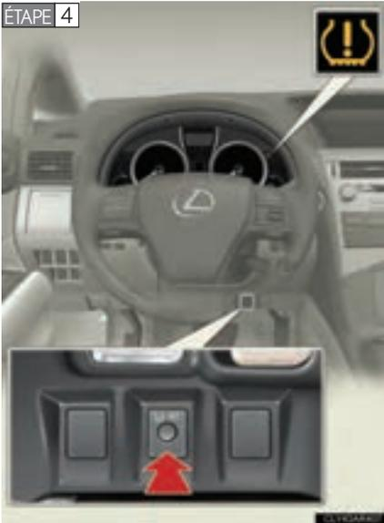
Appuyez longuement sur le bouton de réinitialisation du système d'alerte de pression des pneus, jusqu'à ce que le témoin d'alerte de pression des pneus clignote lentement à 3 reprises.
