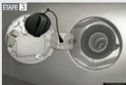
Accrochez le bouchon au dos de la trappe à carburant.
