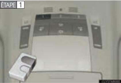
Pointez la télécommande du système à piloter, à une distance comprise entre 1 et 3 in. (25 à 75 mm) des touches de commande HomeLink®.
