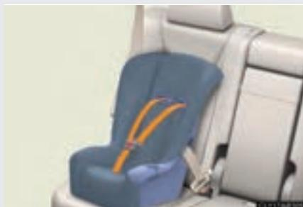
Ceintures de sécurité équipées d'un mécanisme de verrouillage pour sièges de sécurité enfant (ceintures ALR/ELR, sauf celle du conducteur) (→P. 84)
