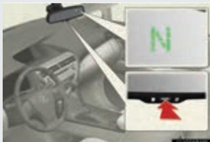
Pour mettre la boussole sur marche ou sur arrêt, appuyez sur "AUTO" pendant plus de 3 secondes.
