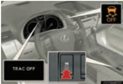
Pour désactiver les systèmes TRAC et VSC, appuyez sur le bouton pendant plus de 3 secondes alors que le véhicule est à l'arrêt.
