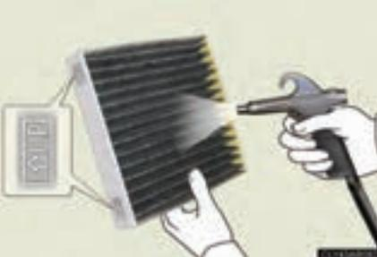
Si le filtre est encrassé, nettoyez-le à l'air comprimé par le dessous.
