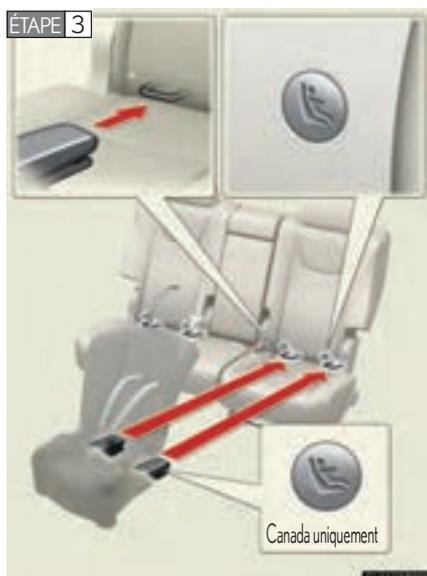
Accrochez les boucles aux points d'ancrage LATCH. Si le siège de sécurité enfant est muni d'une sangle de retenue supérieure, cette dernière doit être arrimée à la patte d'ancrage prévue à cet effet.
