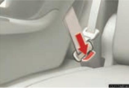
Appuyez sur le bouton de déverrouillage de la boucle et laissez la ceinture de sécurité se rétracter complètement.
