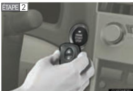
Mettez en contact le côté de la clé électronique portant le logo Lexus avec le bouton de démarrage/d'arrêt moteur "ENGINE START STOP".
