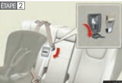
Ouvrez le cache de la patte d'ancrage, attachez le crochet à la patte d'ancrage et tendez la sangle de retenue supérieure.
