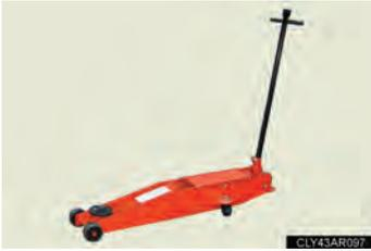
● Levez le véhicule avec un cric du même type que le cric figurant sur l'illustration.
