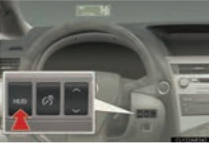
Appuyez sur le bouton pour mettre l'afficheur tête haute sur marche/arrêt et pour sélectionner l'unité d'affichage de la vitesse du véhicule, comme suit:
