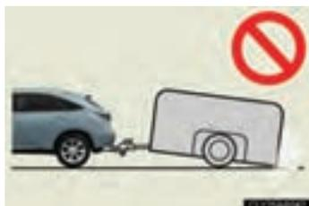
Quelle que soit la catégorie de l'attelage utilisé, pour que la sécurité soit garantie avec la caravane/remorque attachée, il faut que la boule d'attelage soit à la même hauteur que le coupleur de la caravane/remorque.
