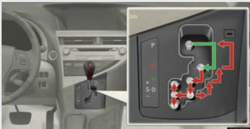
← Bouton de démarrage/d'arrêt moteur "ENGINE START STOP" en mode DÉMARRAGE, appuyez sur la pédale de frein et manœuvrez le sélecteur de vitesses.
