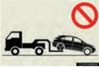
Modèles à 2 roues motrices: Ne remorquez jamais le véhicule par l'arrière, avec les roues avant au sol. La transmission risquerait en effet de subir de graves dommages. Si vous devez remorquer par l'arrière, utilisez des chariots de remorquage.
