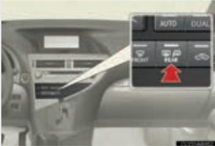
Le dégivrage de la lunette arrière et des rétroviseurs extérieurs est mis sur marche/arrêt
