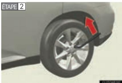
Desserrez d'un tour les écrous de roue.
