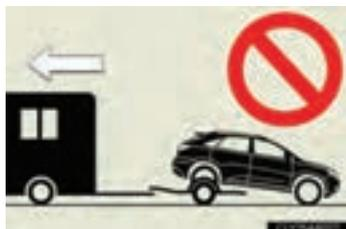
Modèles à 2 roues motrices: Ne remorquez jamais le véhicule par l'arrière, avec les roues avant au sol. La transmission risquerait en effet de subir de graves dommages.
