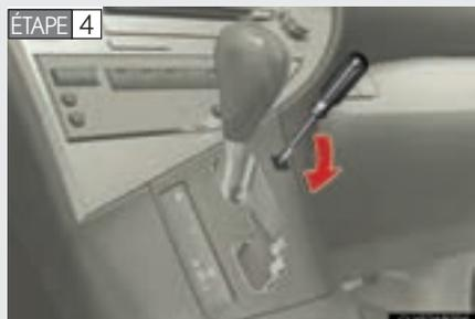
Faites lever sur le cache avec un tournevis plat ou équivalent.
