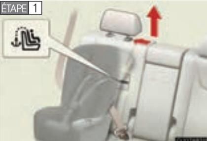
Fixez le siège de sécurité enfant au moyen de la ceinture de sécurité ou du point d'ancrage LATCH, puis démontez l'appui-tête.
