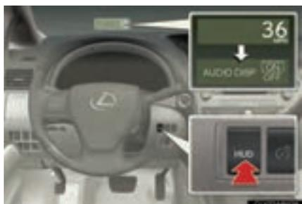
Appuyez sur le bouton principal de l'afficheur tête haute pendant plus de 2 secondes pour afficher le mode marche/arrêt de l'affichage audio. Appuyez sur le bouton principal de l'afficheur tête haute pour mettre l'affichage audio sur marche/arrêt.
