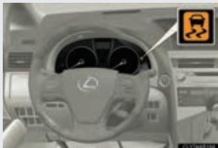
Pour engager l'aide au démarrage en côte, appuyez sur la pédale de frein de quelques millimètres supplémentaires alors que le véhicule est à l'arrêt complet.
