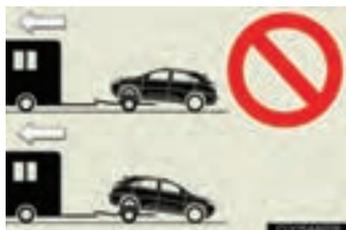
Modèles à 4 roues motrices: Ne remorquez jamais le véhicule avec l'une des roues au sol. La transmission et le système 4 roues motrices à contrôle de couple actif risqueraient en effet de subir de graves dommages.
