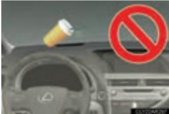
Si un objet tombe dans l'ouverture de l'afficheur tête haute, enlevez-le immédiatement. Par ailleurs, évitez de renverser de l'eau ou tout autre liquide autour de l'ouverture de l'afficheur tête haute, car cela peut causer des dommages mécaniques.
