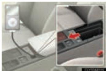
Lorsque le couvercle est ouvert, il est possible de faire passer les fils des appareils audio portables par l'ouverture.
