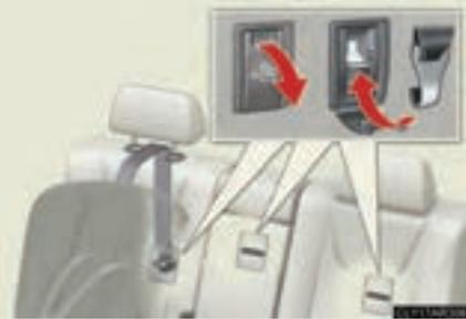
Pattes d'ancrage (pour la sangle de retenue supérieure)
