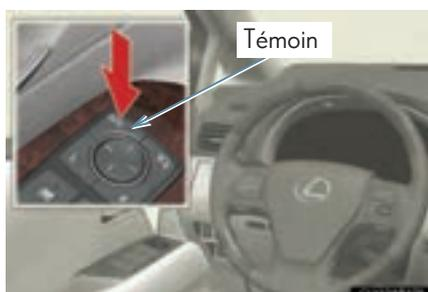
Le mode automatique permet d'asservir la commande des positions repliée/dépliée des rétroviseurs à certaines opérations telles que le verrouillage/déverrouillage des portes.
