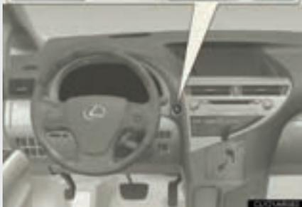
Appuyez sur le bouton de démarrage/d'arrêt moteur "ENGINE START STOP".
