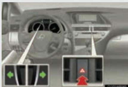
Enfonchez le commutateur des feux de détresse pour déclencher leur fonctionnement. Pour les arrêter, appuyez à nouveau sur le commutateur.
