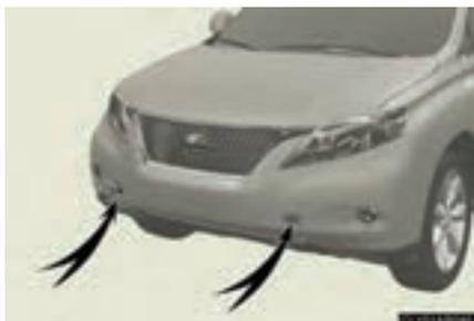
En cas d'indisponibilité d'une dépanneuse ou d'un service d'assistance, vous pouvez remorquer provisoirement votre véhicule à l'aide d'une chaîne ou d'un câble attaché à son anneau de remorquage. Ne le faites que si la route est de bonne qualité, à vitesse réduite et sur une courte distance.
