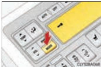
Le boîtier de commande arrière peut être verrouillé à partir de l'écran de fonctionnement de la climatisation. (→P. 374)
