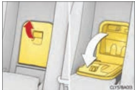
**3** Ouvrez le clapet d'arrivée d'air frais.
