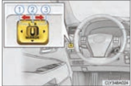
**2** Utilisez la commande pour régler le rétroviseur.
