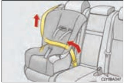
Une fois la sangle diagonale enroulée au point d'être tendue, tirez sur la ceinture pour vérifier qu'elle ne peut plus être déroulée.
