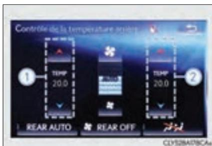
Le système de climatisation passe du mode individuel au mode simultané et inversement à chaque fois que la touche "4-ZONE" est sélectionnée.
