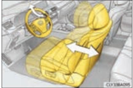
Lorsque l'une des actions a été effectuée, le volant et le siège conducteur retournent automatiquement à leur position d'origine.
