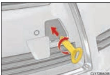
**4** Serrez fermement l'anneau de remorquage à l'aide d'une clé à écrou de roue ou d'une barre métallique dure.
