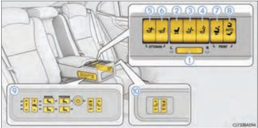
Le siège arrière droit est un siège de relaxation, lequel est équipé d'une fonction de réglage de l'inclinaison du dossier et d'un repose-pied.
