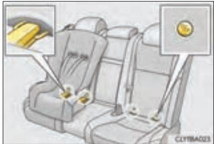
Ceintures de sécurité équipées d'un mécanisme de verrouillage pour sièges de sécurité enfant (ceintures ALR/ELR, sauf celle du conducteur) (→P. 41)
