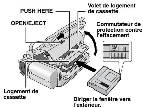
**1** Faire coulisser et maintenir **OPEN/EJECT** dans le sens de la flèche, puis tirer le volet ouvert jusqu'à son blocage. Le logement s'ouvre automatiquement.
