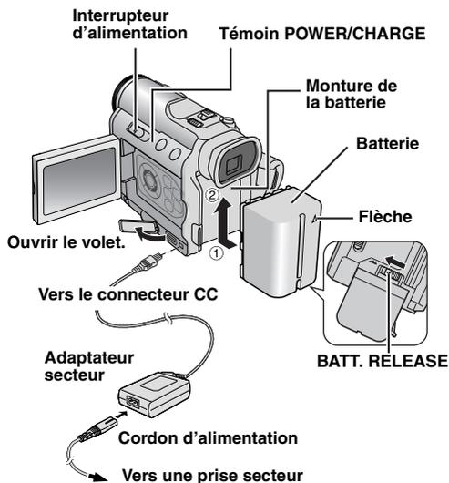
**1** Régler l'interrupteur d'alimentation sur "OFF".
