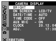
**5** Appuyer sur  $\Delta$  ou sur  $\nabla$  afin de sélectionner "CLOCK ADJ.", et appuyer ensuite sur **SET**. Le paramètre pour le "jour" est illuminé.
