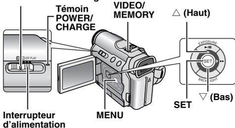
Choisir le mode de fonctionnement approprié en utilisant l'interrupteur d'alimentation et le commutateur VIDEO/MEMORY.
