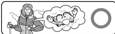
Les batteries lithium-ion sont vulnérables au froid.
