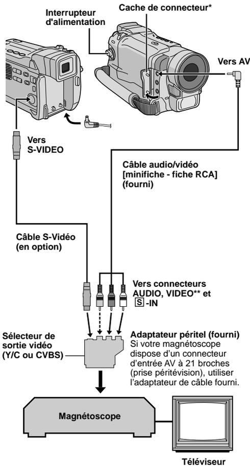
\* Pour raccorder les câbles, ouvrir ce cache.
