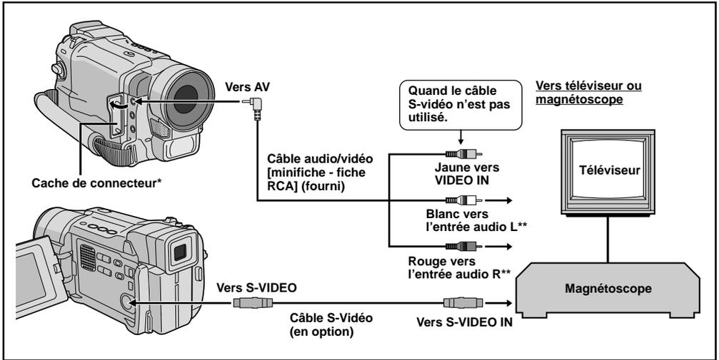
\* Pour raccorder les câbles, ouvrir ce cache.
