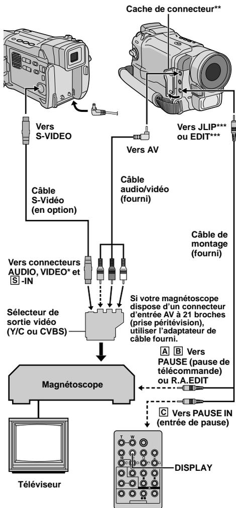
\* Raccorder quand un câble S-Vidéo n'est pas utilisé.
