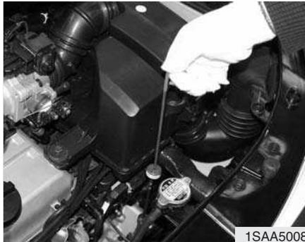
**Vérification du niveau du liquide de la boîte-pont automatique**
