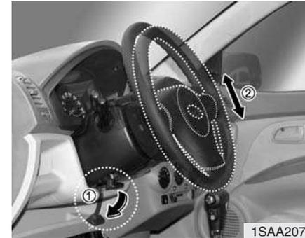
Pour modifier l'angle du volant, abaissez (①) le levier de débloquage, ajustez le volant à votre guise (②), puis soulevez le levier de débloquage pour verrouiller la position du volant. Veillez à régler le volant dans la position souhaitée avant de démarrer.
