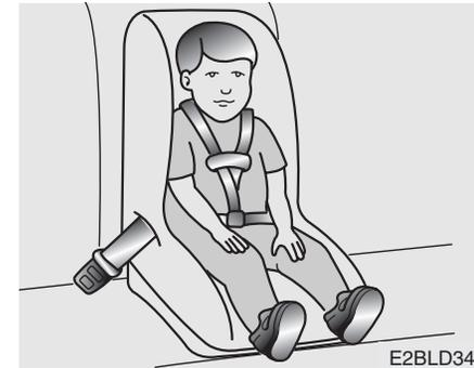
**Installation d'un siège enfants par ceinture ventrale (sur le siège arrière central) (si présent) - Sauf l'Europe**
