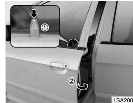
Pour verrouiller une porte sans la clé, placez le levier intérieur de verrouillage des portes (①) en position « LOCK » et fermez la porte (②).
