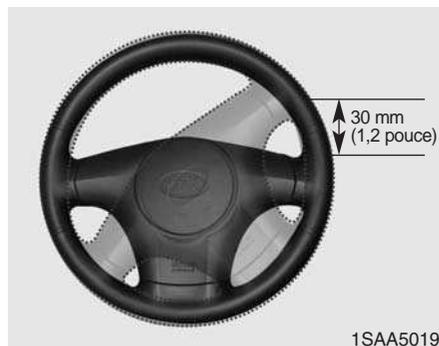
Garez le véhicule sur une surface plane, démarrez, puis placez les roues droites. Tourner le volant à droite et à gauche en forçant un peu et vérifier le jeu jusqu'à temps que vous ressentiez une résistance dans le mouvement des roues.
