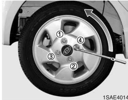
6. Desserrez d'un tour dans le sens contraire des aiguilles d'une montre les écrous de roues, mais n'en enlevez aucun avant que le pneu ait été soulevé au-dessus du sol.
