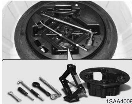
Le pneu de secours, le cric, la manivelle, le crochet de remorquage avant et la clé d'écrous de roues sont placés dans le coffre. Ecartez le tapis pour accéder à ces éléments.
