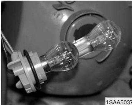
4. Enlever l'ampoule de la douille en appuyant dessus et en la tournant jusqu'à ce que les pattes de l'ampoule s'alignent avec les fentes de la douille. Sortez l'ampoule de la douille.
