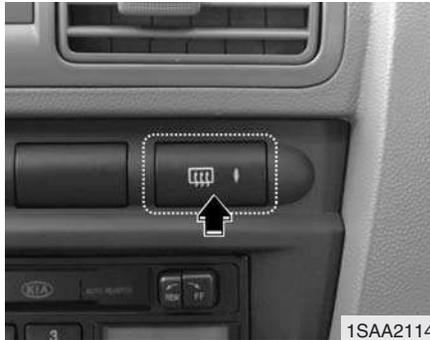
Le dispositif de dégivrage chauffe la vitre et retire le givre et la mince couche de glace située à l'intérieur et à l'extérieur de la lunette arrière pendant le fonctionnement du moteur.
