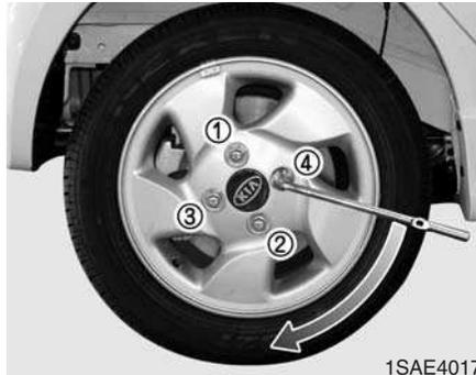
11. Une fois les écrous de roue serrés, abaissez le véhicule complètement jusqu'au sol et poursuivez le serrage des écrous de roue jusqu'à obtention du serrage correct. Serrez fermement les écrous de roue selon un schéma «X».
