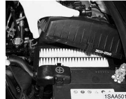
2. Nettoyer l'intérieur du boîtier de l'épurateur d'air avec un chiffon propre et humide.
