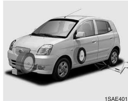
4. Sortez le cric, la poignée du cric, la clé d'écrous de roue et la roue de secours du coffre.
