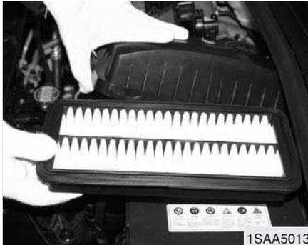
3. Changer l'élément de l'épurateur d'air. Il est recommandé de le remplacer par des pièces Kia d'origine.
