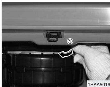
2. Tirez sur les crochets du boîtier de filtre à air du climatiseur (①).
