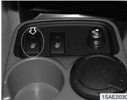
**Chauffage des sièges avant (si présent)**
