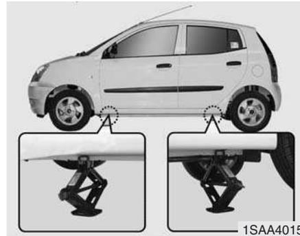
7. Placez le cric à la position avant ou arrière la plus proche de la roue que vous changez. Placez-le aux endroits prévus sous le cadre. Les positions du cric sont constituées de plaques soudées au cadre avec deux pattes et d'un repère saillant qui doit correspondre avec le cric.
