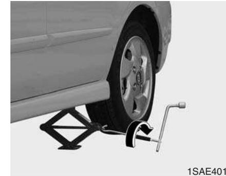
8. Insérez la poignée du cric dans le cric et faites la tourner dans le sens des aiguilles d'une montre en soulevant le véhicule juste assez pour que le pneu quitte le sol. Cette hauteur est d'environ 30 mm (1,2 pouce). Avant de retirer les écrous de roue, assurez-vous que le véhicule est stable et qu'il n'existe aucun risque de mouvement ou de glissement.
