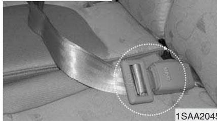
Lors de l'utilisation de la ceinture du siège central arrière, la boucle avec l'inscription «CENTER» doit être utilisée.
