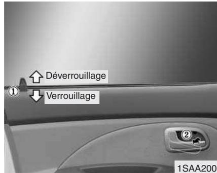
**Actionnement du verrouillage des portes de l'intérieur du véhicule**
