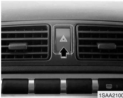
Le clignotant des feux de détresse provoque le clignotement des feux rouges arrière et des feux de signalisation de changement de direction avant pour informer les autres conducteurs qu'ils doivent rouler prudemment à l'approche de votre véhicule.
