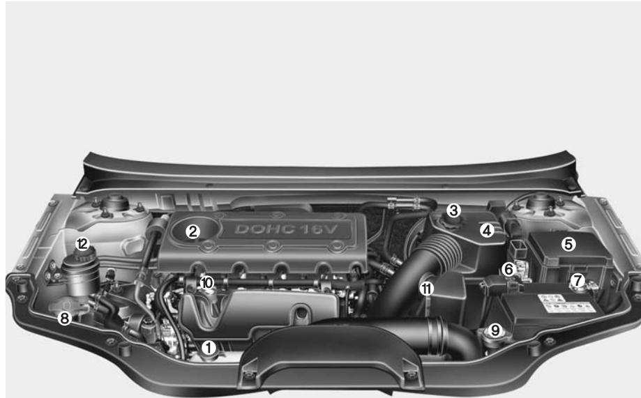
1. Réservoir du liquide de refroidissement .....7-16
