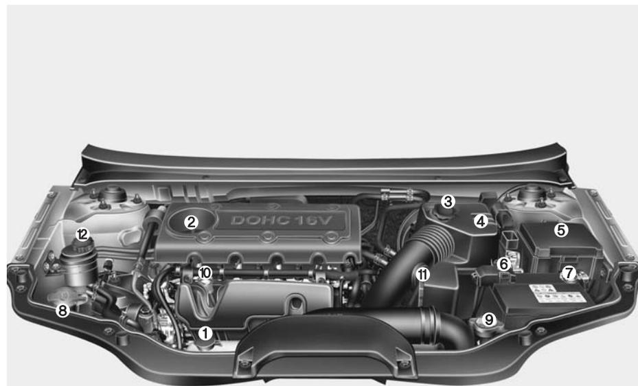
1. Réservoir du liquide de refroidissement
