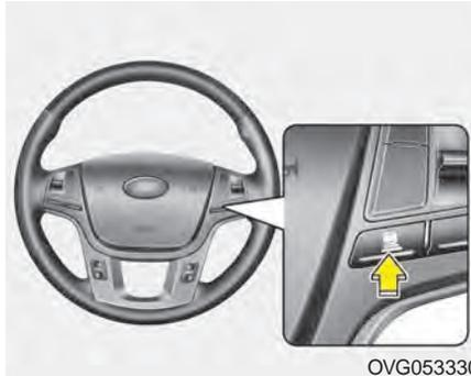
Cette fonction vous permet de programmer le véhicule de façon à ce qu'il maintienne une distance constante (établie par le détecteur) avec le véhicule devant vous sans que vous ayez à appuyer sur l'accélérateur ou la pédale de frein.
