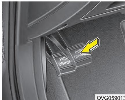
Vérifiez si le déplacement satisfait la spécification quand la pédale de frein de stationnement est pressée avec une pression de 20 kg (44 lb ou 196 N). De plus, le frein de stationnement seul devrait retenir le véhicule dans une pente assez prononcée.
