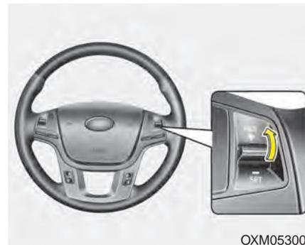
Si la vitesse prédéterminée est annulée d'une autre façon qu'en utilisant la touche Cruise, et si le régulateur de vitesse est toujours activé, on peut reprendre la vitesse prédéterminée en soulevant le levier vers RES+. Pour reprendre à la vitesse choisie le plus récemment, soulever le levier vers RES+. Par contre, la vitesse ne reprendra pas si la vitesse du véhicule est descendue à moins de 25 mi/h (40 km/h) environ.
