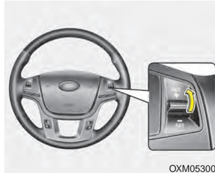
Si on a fait appel à une méthode autre que le bouton du RÉGULATEUR DE VITESSE pour annuler la vitesse de croisière et si le système est encore activé, la vitesse de consigne la plus récente sera automatiquement rétablie au moment de déplacer le levier vers le haut (à RES+).
