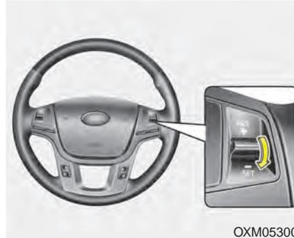
3. Le levier doit être abaissé (sur la position SET-) avant de pouvoir enregistrer la vitesse désirée. Relâcher en même temps la pédale d'accélérateur. La vitesse choisie sera maintenue automatiquement.
