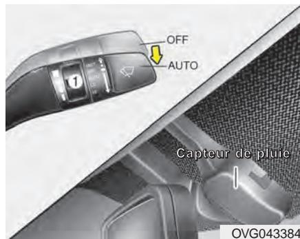
Le détecteur de pluie, situé à l'extrémité supérieure du pare-brise, détecte la quantité de pluie et contrôle le cycle d'essuyage selon l'intervalle qui convient. Plus il pleut, plus les essuie-glaces fonctionnent rapidement. Lorsque la pluie cesse, les essuie-glaces s'arrêtent.
