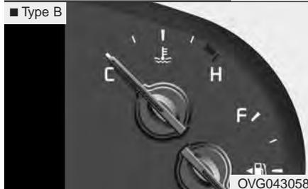
Cet indicateur indique la température du liquide de refroidissement du moteur lorsque le commutateur d'allumage ou le bouton Engine Start/Stop (mise en marche/arrêt du moteur) est ACTIVÉ.
