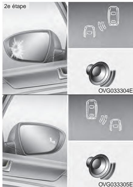
L'alarme de deuxième niveau s'actionnera dans les cas suivants :
