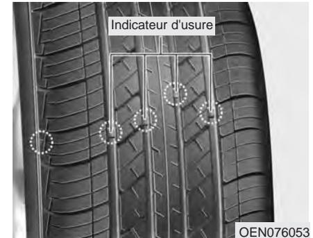
Si l'usure du pneu est uniforme, l'indicateur d'usure apparaît sous forme d'une bande solide en travers de la semelle. L'indicateur apparaît quand il reste moins de 1,6 mm (1/16 po) de semelle sur le pneu. Remplacez le pneu quand l'indicateur apparaît.
