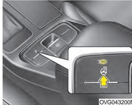
Lorsque le commutateur d'allumage se trouve en position **ACTIVÉ**, une pression sur le bouton du volant de direction a pour effet de réchauffer celui-ci. Le témoin sur le bouton s'allumera et vous avisera sur l'affichage ACL.
