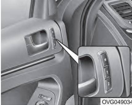
Un système de mémoire de position du conducteur met en mémoire et rappelle les positions du siège du conducteur, du rétroviseur extérieur et du volant au simple toucher d'un bouton\*. En sauvegardant les positions voulues dans la mémoire du système, les différents conducteurs peuvent repositionner le siège du conducteur, le rétroviseur extérieur et le volant selon leur préférence de conduite.
