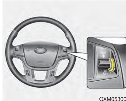
3. Le levier doit être abaissé (sur la position SET-) avant de pouvoir enregistrer la vitesse désirée. Le témoin lumineux RÉGLER s'allumera dans le groupe d'instruments. Relâcher la pédale d'accélérateur en même temps. La vitesse désirée sera automatiquement maintenue.
