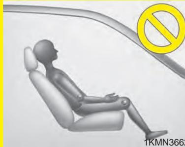
Quand le véhicule est en mouvement, le conducteur doit demander au passager de garder le dossier du siège en position redressée. Si un accident survient et que le dossier du siège est incliné, la capacité de retenue de la ceinture de sécurité sera grandement réduite.
