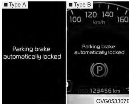
Si le frein de stationnement électrique (EPB) est appliqué, alors que le maintien automatique (Auto Hold) est activé par un signal du programme de stabilité électronique, un carillon avertisseur se fera entendre et un message d'avertissement s'affichera.
