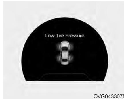
Si les voyants du système de surveillance de la pression des pneus s'allument et qu'un message apparaît sur l'écran du tableau de bord, cela signifie que l'un des pneus est sérieusement sous-gonflé. Le voyant de position du pneu sous-gonflé indique le pneu fautif en illuminant le pneu correspondant sur le tableau de bord. Si un témoin s'illumine, ralentissez immédiatement, évitez les virages serrés et prévoyez une distance de freinage accrue.
