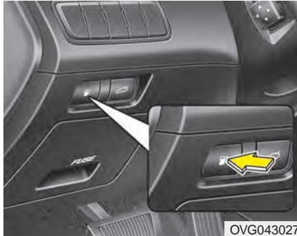
Le volet du réservoir de carburant doit être ouvert de l'intérieur du véhicule en tirant le levier d'ouverture du volet du réservoir de carburant.
