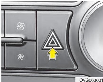
Les feux de détresse s'allument quand vous appuyez sur le commutateur des feux de détresse. Les feux clignotent dans les deux directions. Les feux de détresse fonctionnent même si la clé n'est pas dans le commutateur d'allumage.
