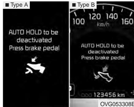
Si la conversion entre le mode de maintien automatique (Auto Hold) et le frein de stationnement électrique (EPB) ne fonctionne pas correctement, un carillon avertisseur se fera entendre et un message d'avertissement s'affichera.
