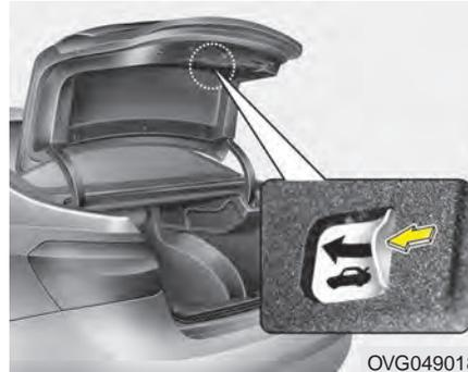
Votre véhicule est équipé d'un câble d'ouverture d'urgence, à l'intérieur du coffre. Si, par inadvertance, quelqu'un s'enferme dans le coffre, tirer la poignée actionne le mécanisme de fermeture du coffre et ouvre le couvercle.
