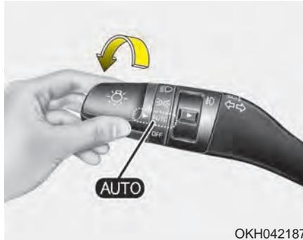
Les phares avant adaptatifs détectent l'angle de direction et la vitesse du véhicule pour optimiser la visibilité en faisant pivoter les phares avant ou en modifiant le niveau du faisceau d'éclairage. Placer le commutateur en position AUTO pendant que le moteur tourne. Les phares avant adaptatifs seront activés quand les phares avant sont allumés.
