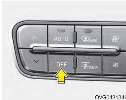
Appuyez sur le bouton OFF pour éteindre la climatisation automatique. Vous pouvez toujours utiliser les boutons de mode et d'admission d'air en autant que le commutateur d'allumage soit en position ON.
