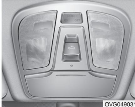
Si votre véhicule est pourvu d'un toit ouvrant, vous pouvez le faire glisser ou l'incliner au moyen du levier de commande du toit ouvrant situé sur la console supérieure.
