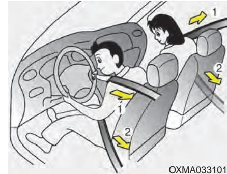
Le véhicule est muni de ceintures de sécurité à pré-tendeur pour le conducteur et le passager avant (pré-tendeur de rétracteur et EFD [système d'attache d'urgence]). Les ceintures de sécurité à pré-tendeur peuvent être activées lorsque la collision frontale est suffisamment grave, en plus des coussins de sécurité gonflables.
