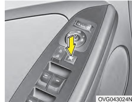
Le conducteur peut verrouiller les commutateurs d'ouverture/de fermeture des glaces arrière en appuyant sur le commutateur de verrouillage des glaces (la position verrouillage est la position appuyée).
