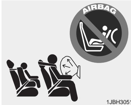
Ne placez jamais un appareil de retenue pour enfant qui fait face vers l'arrière, sur le siège de passager avant. Si le coussin gonflable se déploie, il pourrait frapper l'appareil de retenue, causant des blessures graves ou mortelles.
