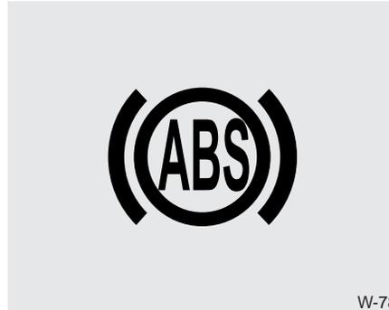
Le témoin des freins ABS s'allume pendant 3 secondes après que le commutateur est mis sur ON. Le témoin s'éteint après ce temps d'autodiagnostic de l'ABS, s'il fonctionne normalement. Si le témoin reste allumé, l'ABS est en panne, mais les freins fonctionnent toujours. Communiquer avec un concessionnaire agréé Kia aussitôt que possible.
