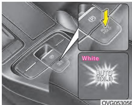
1. Appuyer sur la pédale de frein et appuyer sur la touche de maintien automatique (Auto Hold). Un voyant AUTO HOLD de couleur blanche apparaîtra, ce qui indique que le dispositif est en veille. Pour que le frein de stationnement électrique (EPB) fonctionne, le conducteur doit d'abord fermer sa portière, le capot et le coffre, puis boucler sa ceinture de sécurité.
