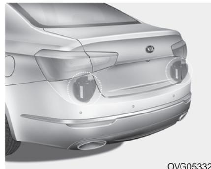
Les capteurs sont placés à l'intérieur du pare-chocs arrière.
