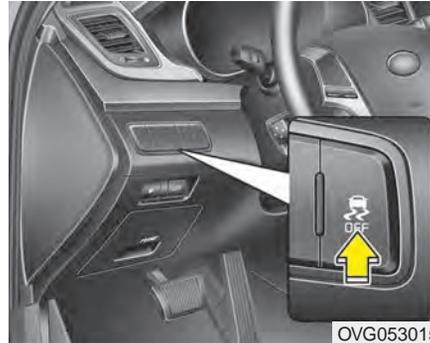
Le système de contrôle électronique de stabilité (ESC) sert à stabiliser le véhicule quand vous négociez des virages. L'ESC compare la direction dans laquelle vous voulez aller avec celle que prend le véhicule. L'ESC applique les freins à chaque roue et prend charge du système de gestion du moteur afin de stabiliser le véhicule.
