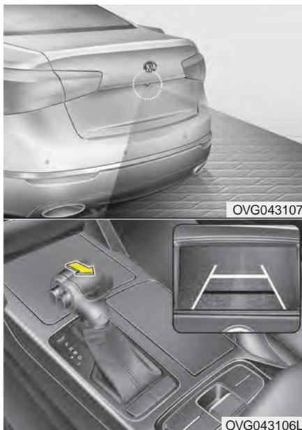
La caméra de rétrovisée se met en circuit quand les feux de marche arrière s'allument alors que le commutateur d'allumage est sur ON et que le levier de vitesses est sur R. Ce dispositif complémentaire permet de voir sur un écran AV, ce qui se trouve derrière le véhicule lors de la marche arrière.
