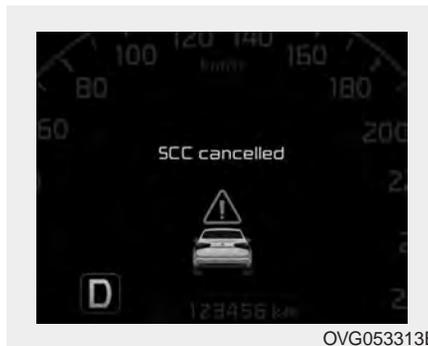
Si le régulateur de vitesse intelligent est annulé, un carillon avertisseur retentira et un message s'affichera pendant quelques secondes. La vitesse du véhicule doit être ajustée, en appuyant sur la pédale d'accélérateur ou la pédale de frein, en fonction des conditions routières. Toujours prêter attention aux conditions routières. Ne pas se fier au carillon avertisseur.
